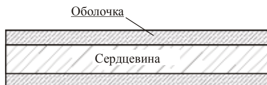
Рис. 2.109. Структура проволоки Виганда
