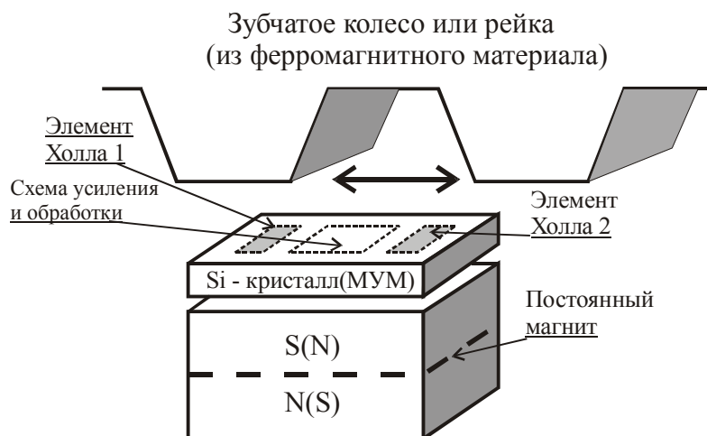
Рис. 3.45. Размещение кристалла МУМ и постоянного магнита при работе магнитоуправляемой ИС в качестве датчиков скорости вращения зубчатых колес и перемещения реек из ферромагнитных материалов
