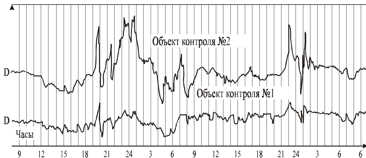
Рис. 6.87. Характер изменения напряженности магнитного поля Земли при использовании ИБМ типа МФ-03
