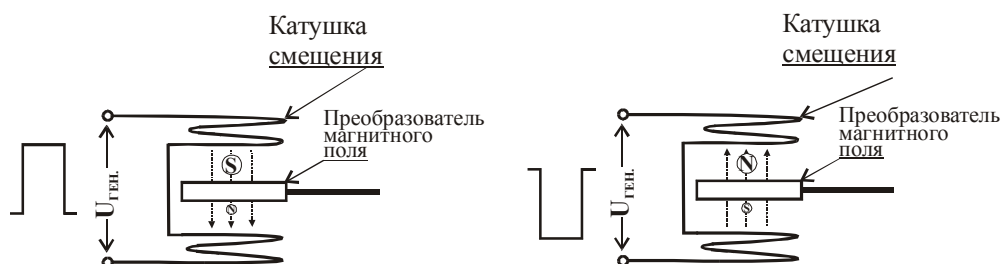
Рис. 6.36. Иллюстрация принципа квазимодуляции
