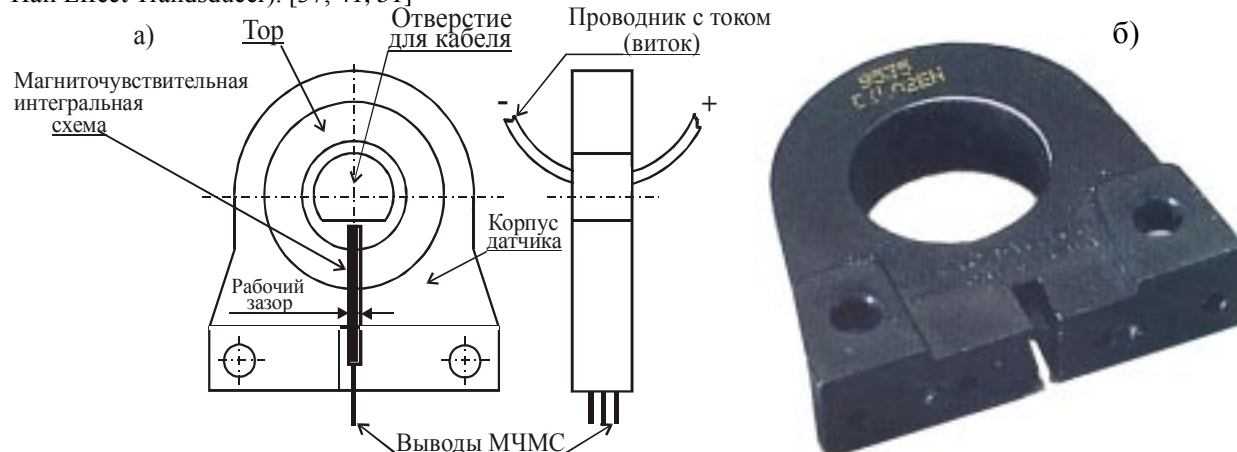
Рис. 5.108. Датчик тока типа LONET I (LONET II): а - конструкция; б - внешний вид
