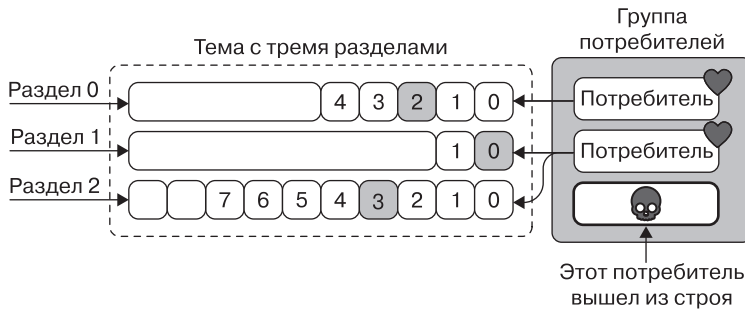
Рис. 1.13. Прекращение работы одного из потребителей ведет к переконфигурированию нагрузки
