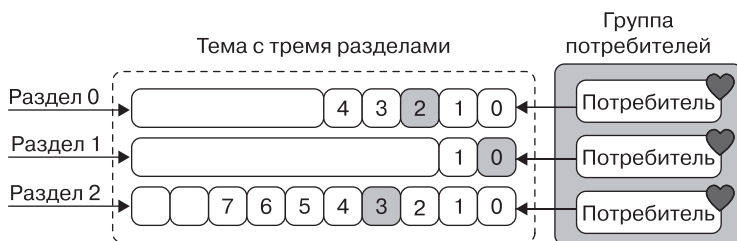
Рис. 1.12. Три активных потребителя делят между собой нагрузку чтения/обработки в трех разделах темы Kafka
