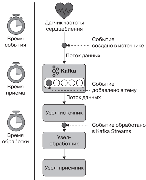
Рис. 5.2. Разные семантики времени в Kafka Streams на примере измерения частоты сердцебиения
