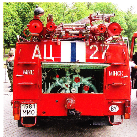
Насосный отсек пожарной автоцистерны АЦ-30(53А)-106В
