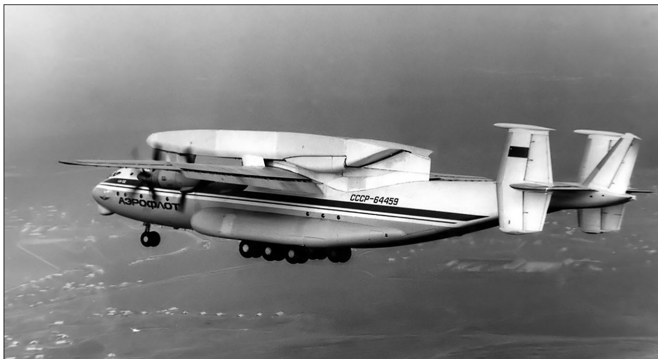
Транспортировка центроплана Ан-225 самолетом Ан-22 из Ташкента
