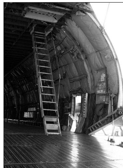
Слева: Лестница, ведущая в кабину сопровождающих. Справа: Лестница, ведущая в кабину экипажа и каюты для отдыха
