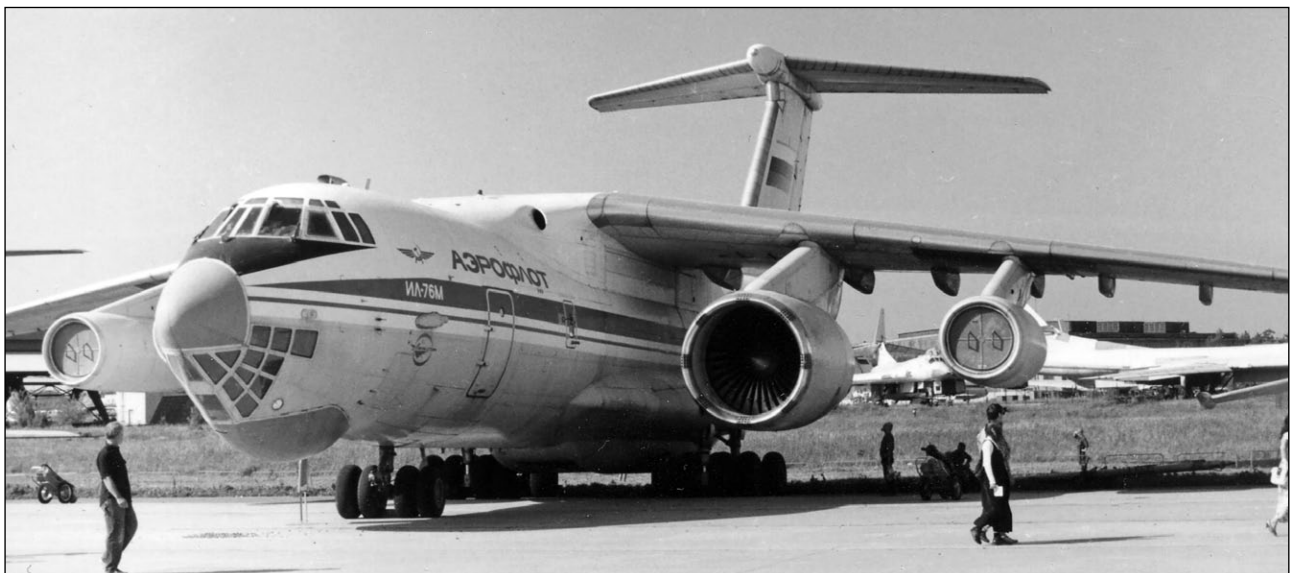
Летающая лаборатория Ил-76ЛЛ для испытаний двигателя Д-18Т
