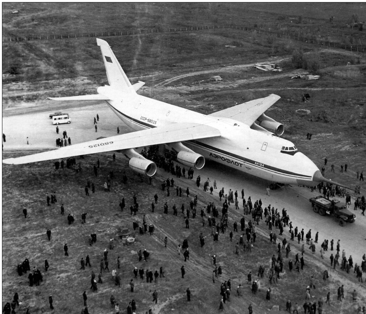
Выкатка первого экземпляра Ан-124 из сборочного цеха завода. На носовой части фюзеляжа на время испытаний установлена штанга крепления приемника воздушного давления (ПВД)
