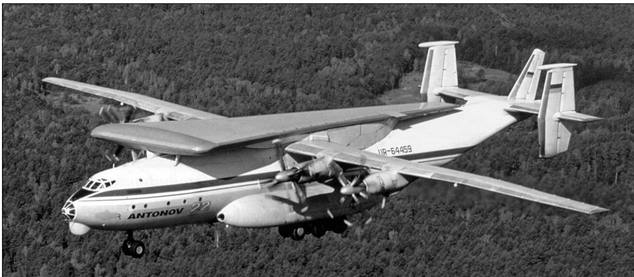
Транспортировка консоли крыла Ан-124 на фюзеляже самолета Ан-22
