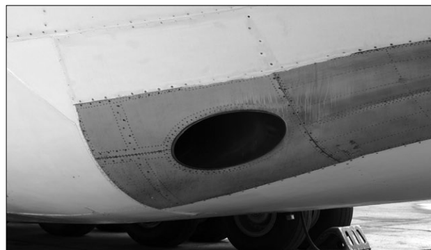
Сопло левой вспомогательной силовой установки
