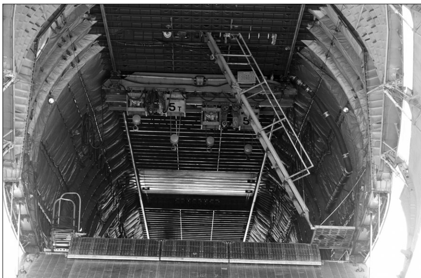
Слева: Лестница, ведущая в кабину сопровождающих. Справа: Лестница, ведущая в кабину экипажа и каюты для отдыха
