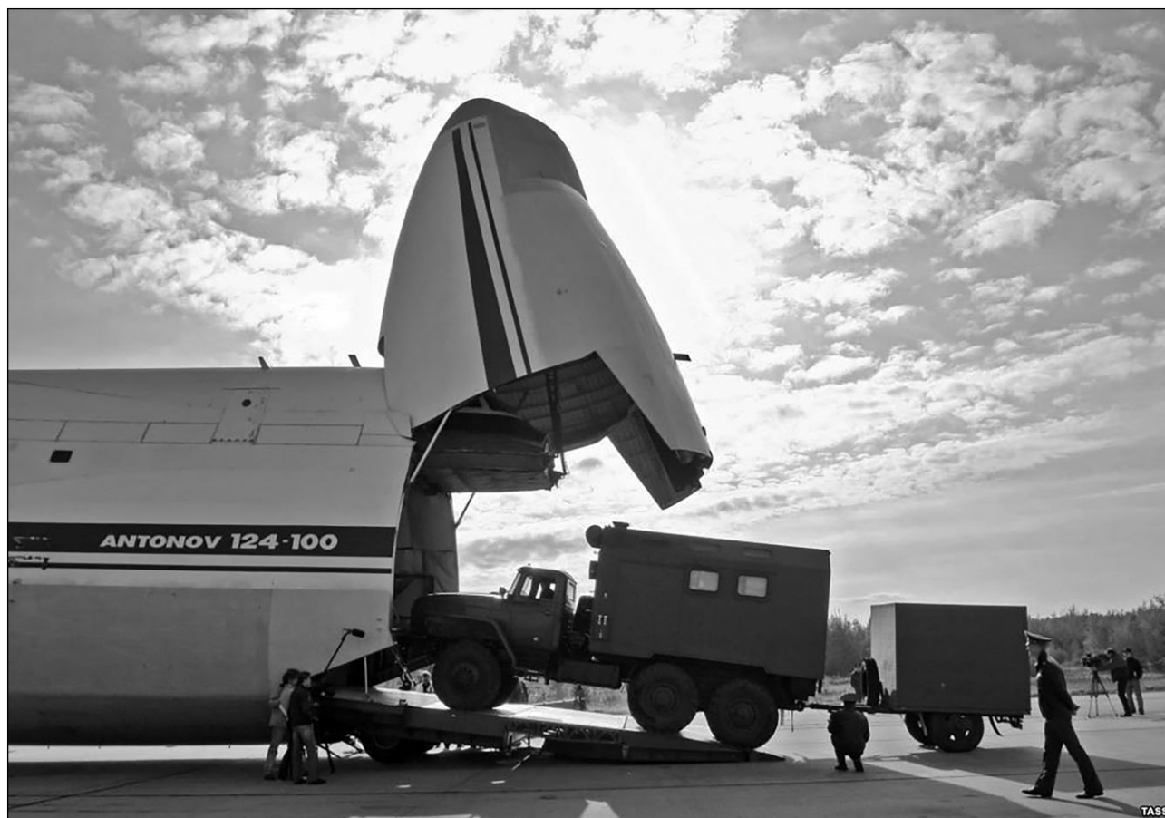
Загрузка автомобиля «Урал» с прицепом с топографическим оборудованием в Ан-124-100 224-го летного отряда. Фото из архива Г. Петрова
