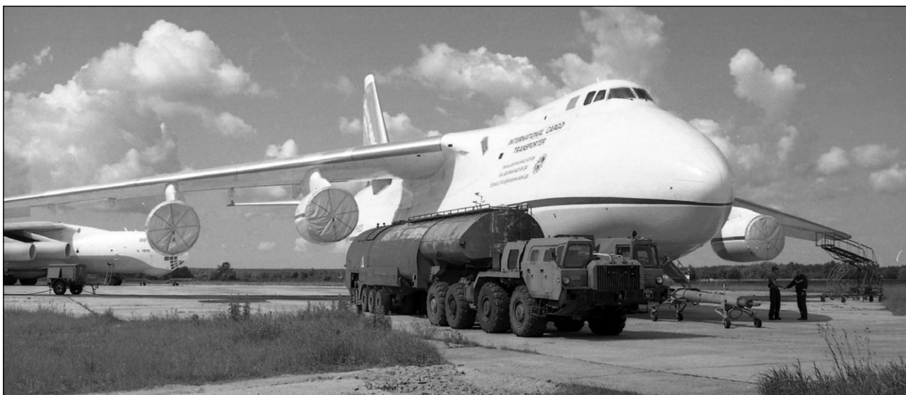
При полной заправке в баки Ан-124-100 заливается свыше 260 тонн керосина
