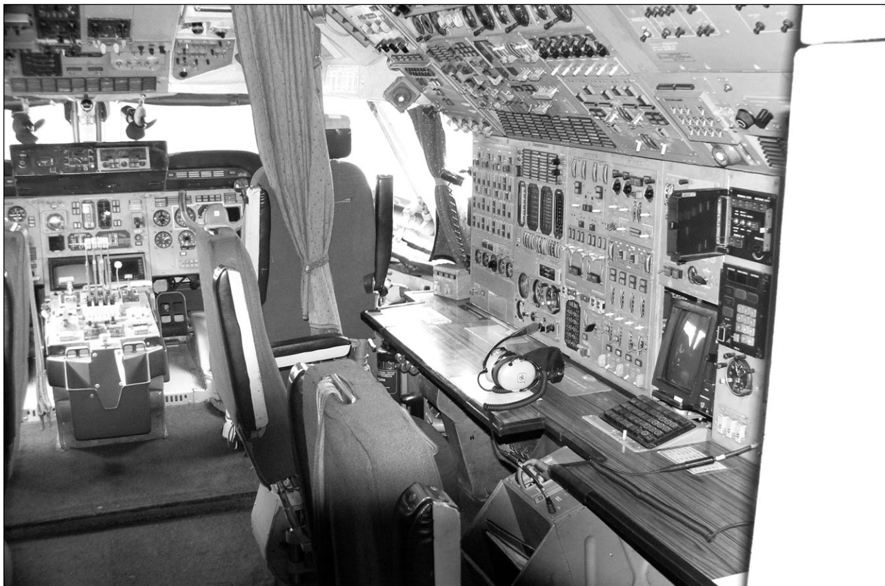
Рабочие места бортинженера и электрика
