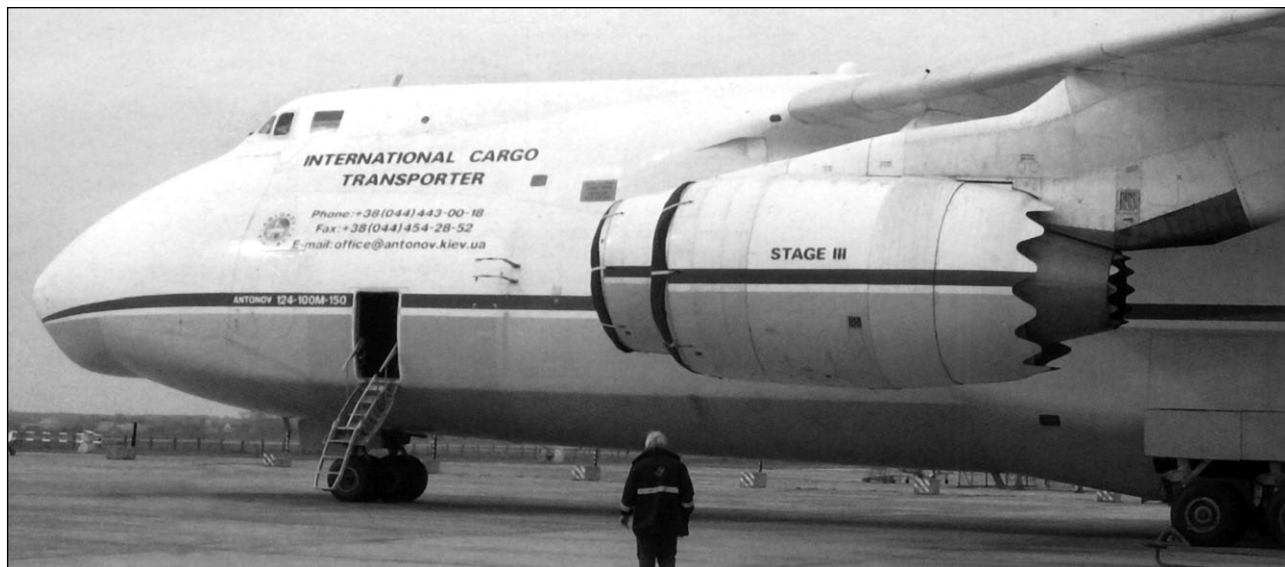
На Ан-124-100М-150 сделали попытку снизить уровень шума, создаваемого двигателями. Для этого заднюю кромку мотогондолы и сопла двигателя сделали пилообразными
