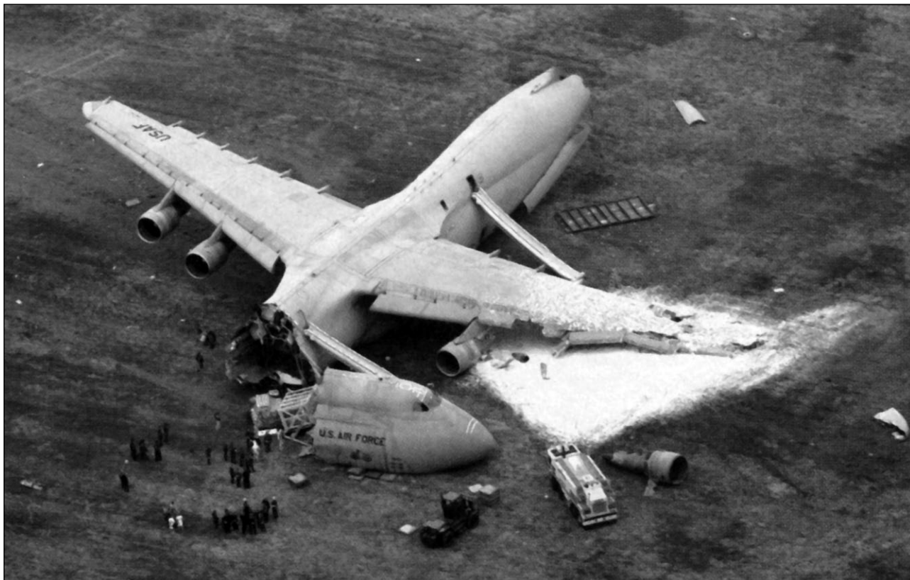
Аварийная посадка С-5В, видимо, связанная с пожаром левого крайнего двигателя. Видны надувные трапы, оторвавшийся двигатель, залитая пеной левая консоль крыла и пожарная машина
