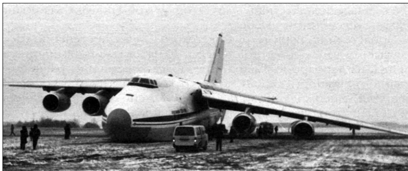
В канун 1994 года, 30 декабря, при посадке на аэродроме Гостомель Ан-124-100 выкатился за пределы ВПП, подломав шасси
