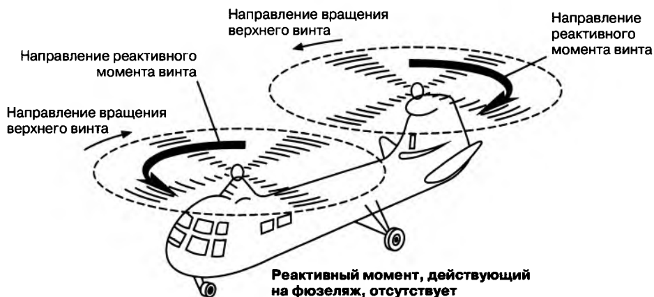
Рис. 7.6. Вертолет с двухвинтовой продольной схемой размещения винтов
