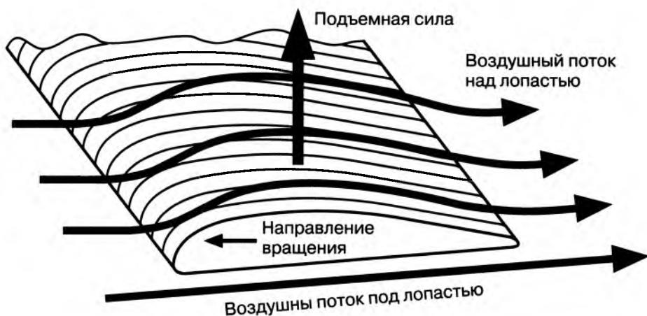
Рис. 8.1. Создание подъемной силы лопастью несущего винта
