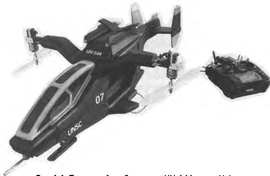
Рис. 1.1. Так выглядит бикоптер UH-144 серии Halo (построен Феликсом Мисюцким)
