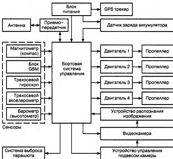
Рис. 13.8. Функциональная схема продвинутого квадрокоптера
