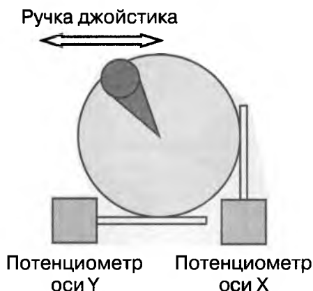
Рис. 22.3. Как мог бы быть устроен джойстик
