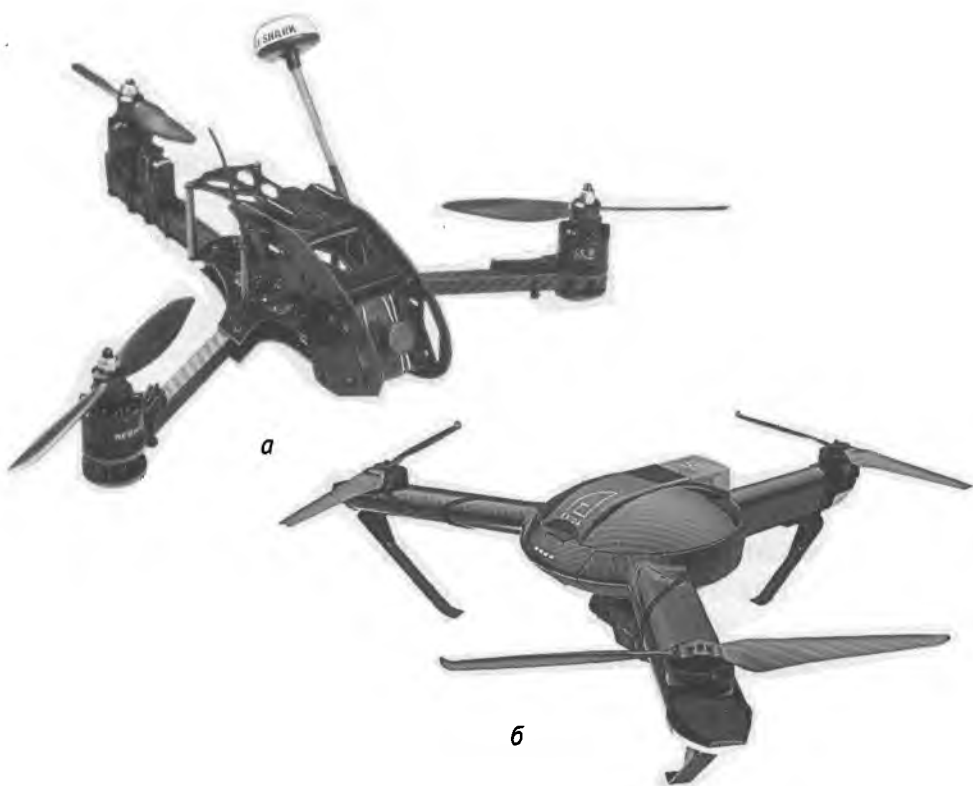
Рис. 1.2. Так выглядят трикоптеры: а – гоночный трикоптер RCEXplorer, разработанный компанией MiniTricopter б – трикоптер Yi Erida, разработанный компанией Yi Technology. Легкий и прочный карбоновый корпус, скорость до 120 км/час и до 40 минут полета от одного заряда аккумулятора
