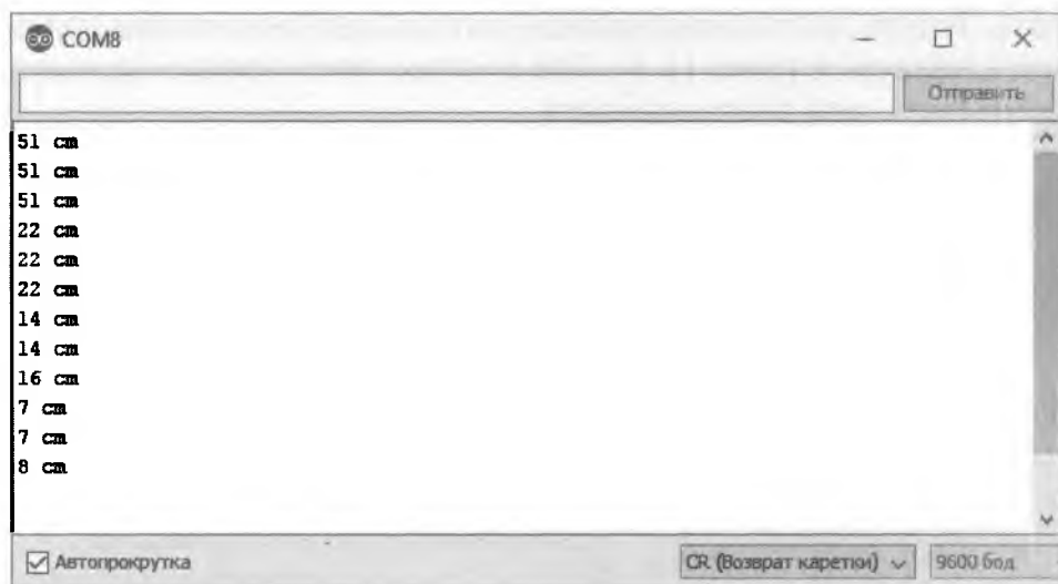
Рис. 16.5. Результаты работы ультразвукового датчика на экране монитора порта
