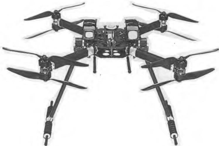
Рис. 1.6. Соосный квадрокоптер CZ Quadro-condor, созданный по схеме «X8»
