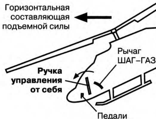
Рис. 9.2. Для движения вперед пилот двигает ручку управления от себя
