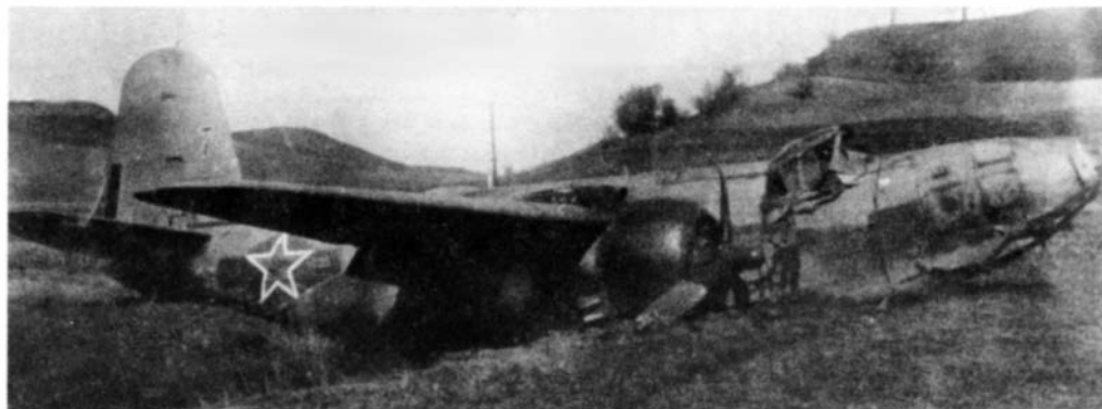
A-20G, переделанный в невооруженный буксировщик мишеней-конусов. Пилот Коробков потерпел на нем аварию в июне 1947 г. у села Кехта под Архангельском из-за отказа мотора
