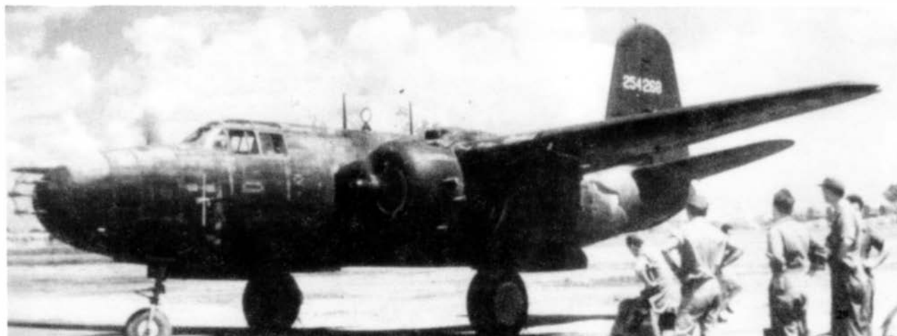
Этот Р-70 переделан из А-20G в Австралии и отличается от машин американской постройки по размещению антенн
