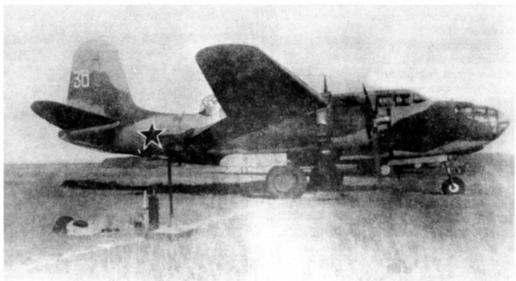
Б-3, переделанный под советское вооружение. На самолете на переднем плане ясно видна турель УТК-1
