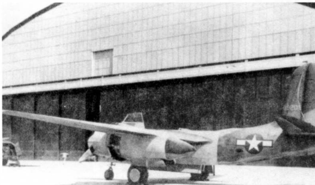
А-20С, переделанный в бронированную пилотируемую мишень
