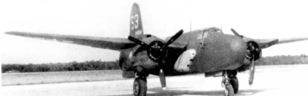
Р-70В-1 был доработан из А-20G-10 и оборудован радиолокатором SCR 720 в носовой части фюзеляжа
