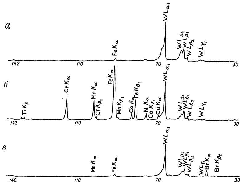
Рис. 7. Рентгеноспектральный анализ (вольфрамовая трубка) чистого бора, полученного восстановлением \text{BBr}_3 водородом при 1300^\circ\text{C} на танталовой нити (а), промышленного образца бора, применяющегося для синтеза \text{BBr}_3 (б), и чистого бора, полученного восстановлением \text{BBr}_3 водородом при 750^\circ\text{C} на внутренней стенке кварцевой трубки (в).
