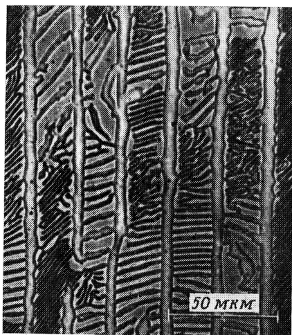
Рис. 22. Продольный разрез комбинированного композитного материала Co-(Co-Co_2Si) ; \times 500 .
