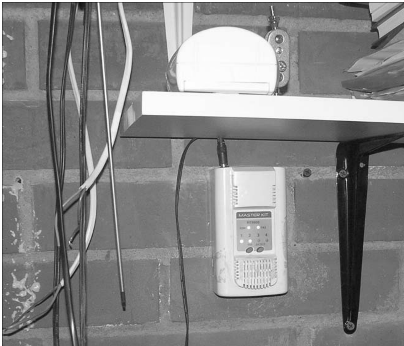
Рис. 1.34. Установка основного блока скрытно на стене лоджии
