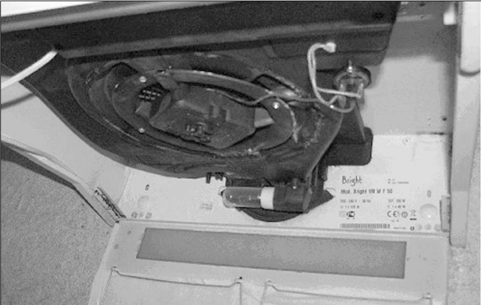
Рис. 1.16. Установка датчика пыли CG-P1 внутри вытяжки Bright
