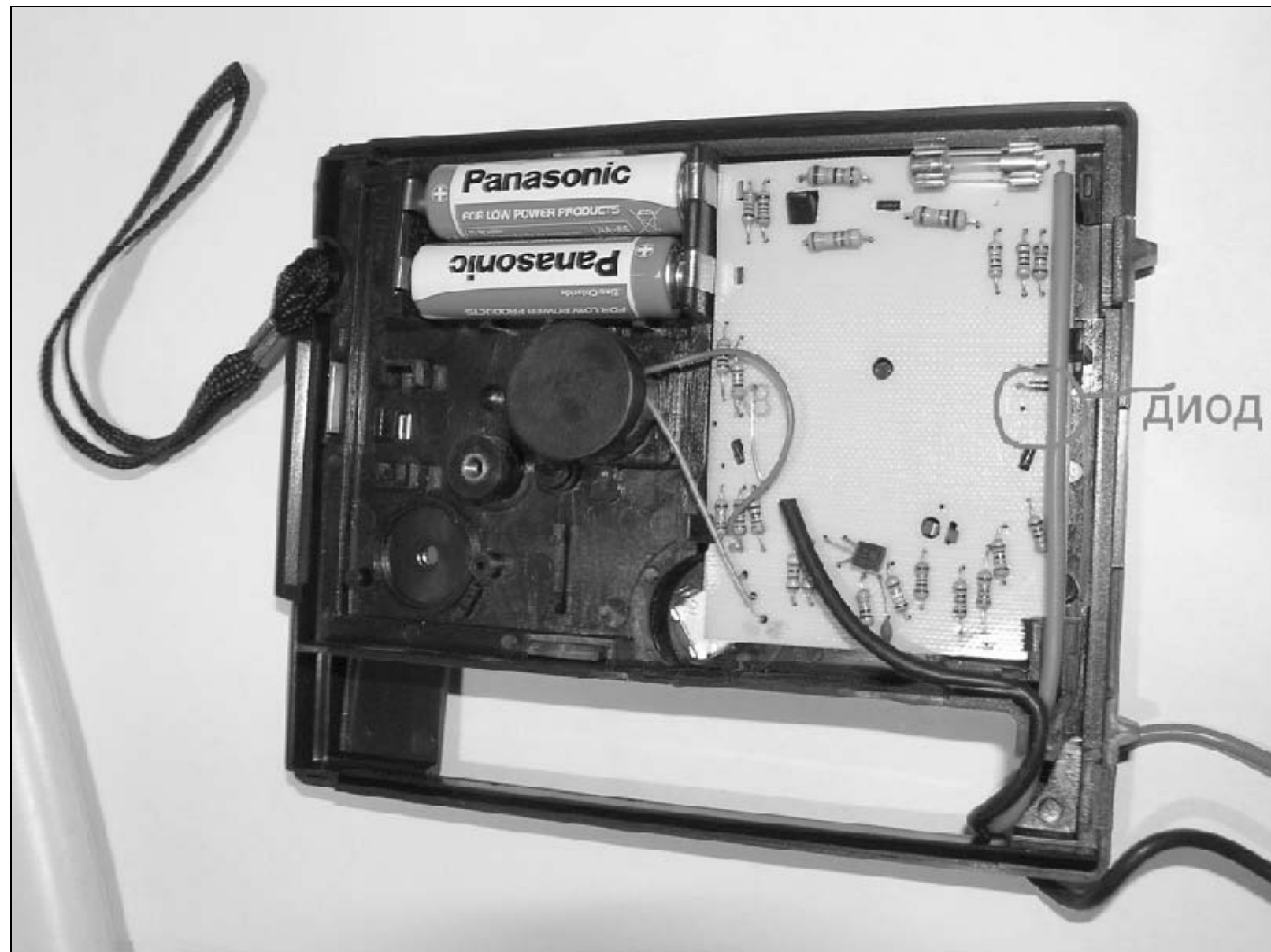
Рис. 3.3. Вид с открытым корпусом тестера YX-360TRD
