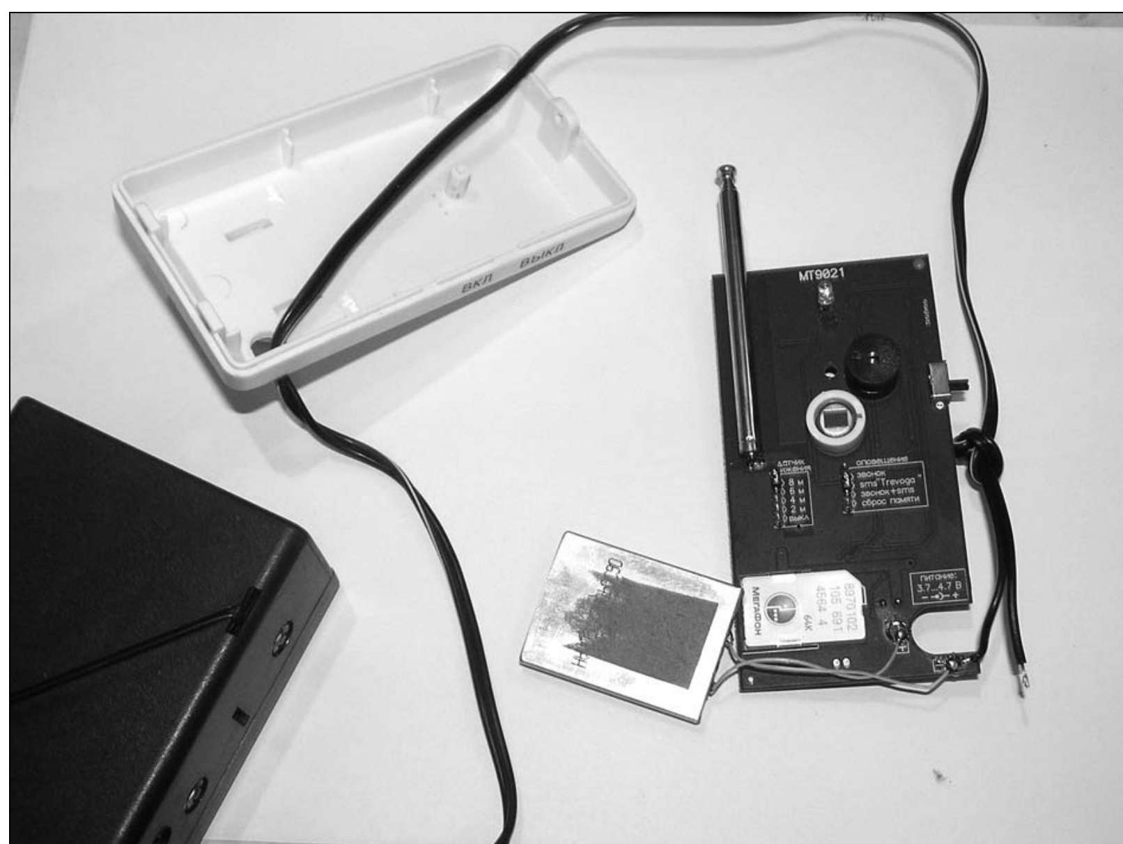
Рис. 1.52. Вид на подключенный АКБ AP-Li-10B/12B
