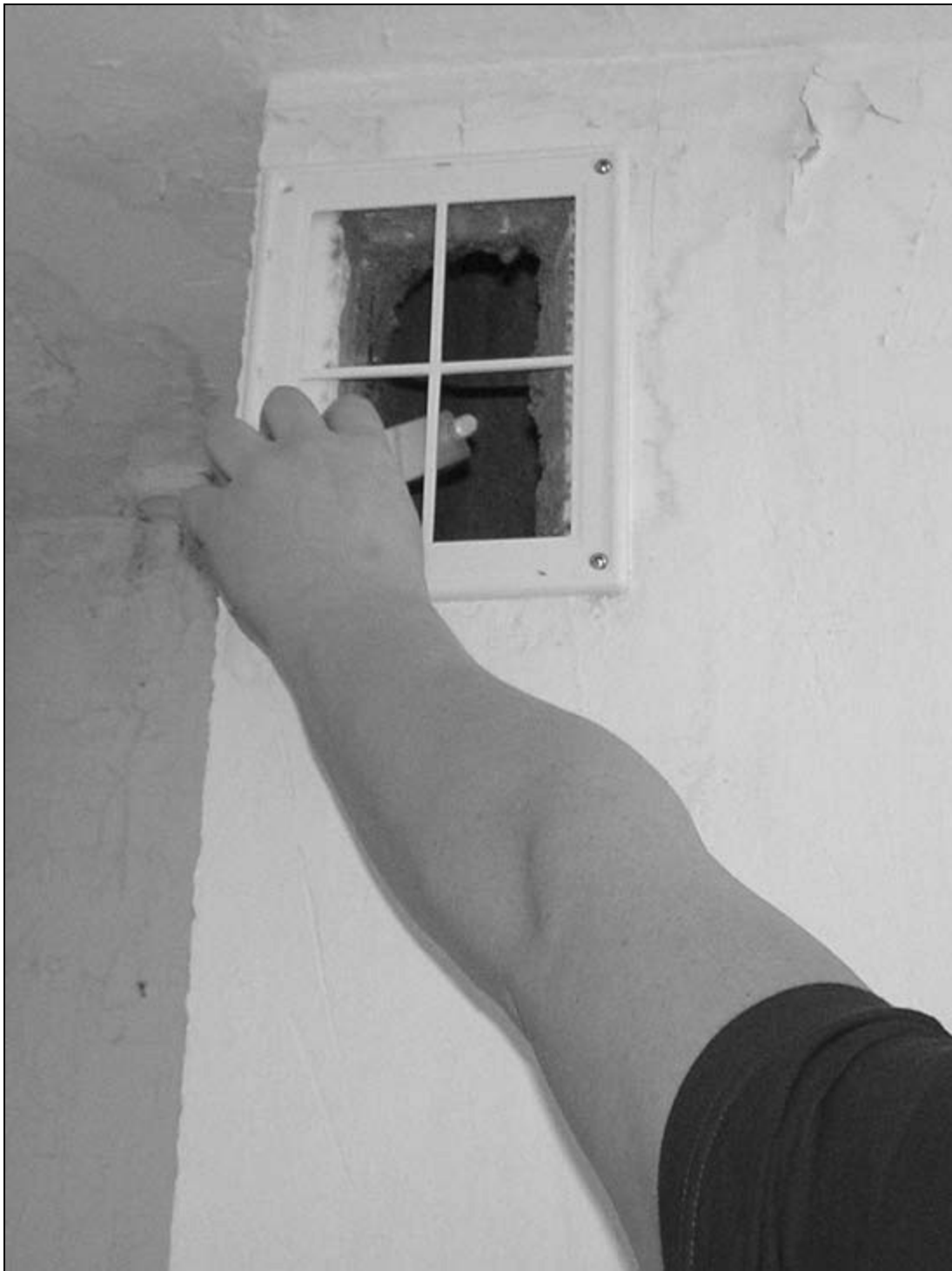
Рис. 1.9. Применение прибора для контроля тяги вытяжки
