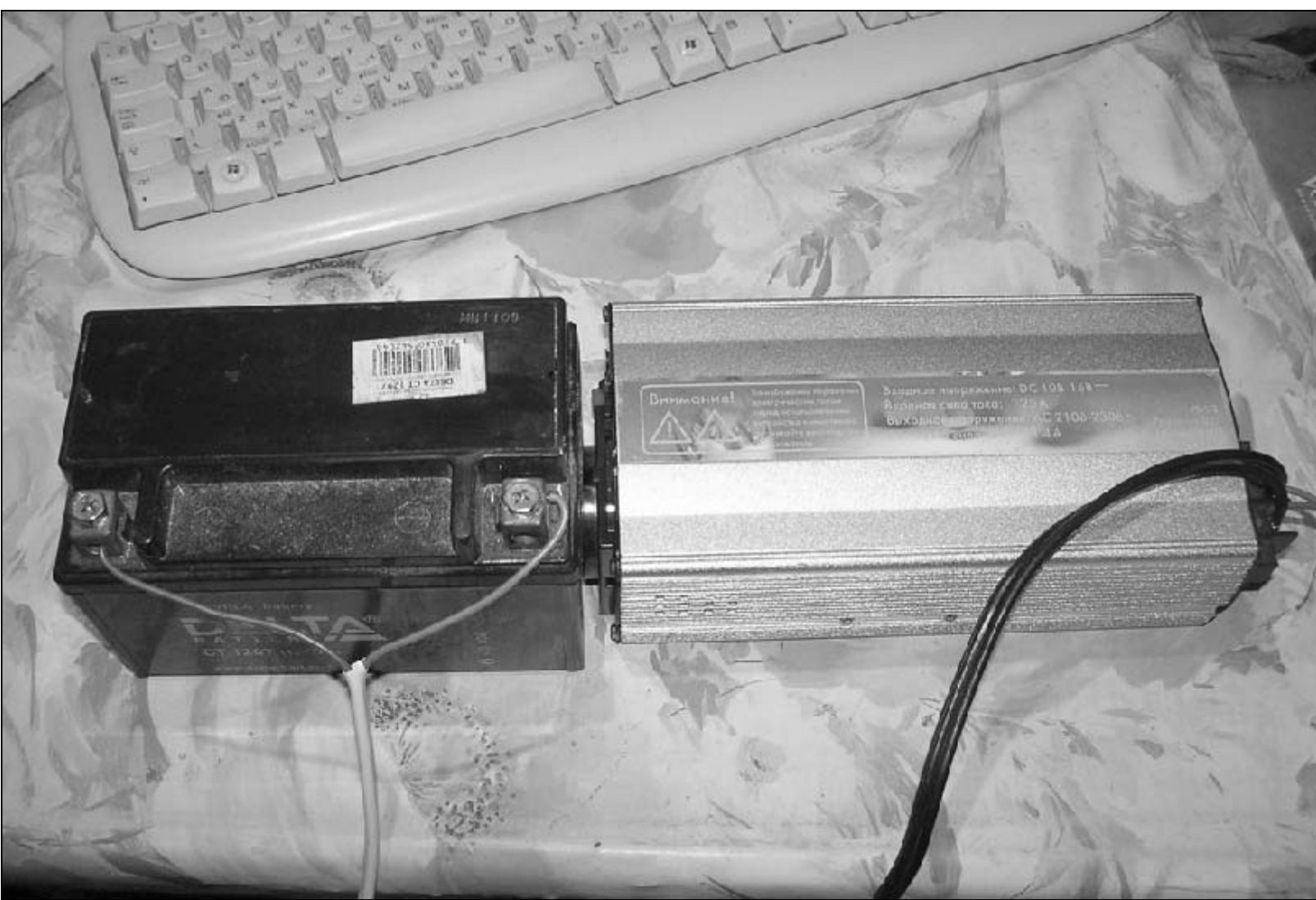
Рис. 3.29. Преобразователь, подключенный к АКБ CT1207
