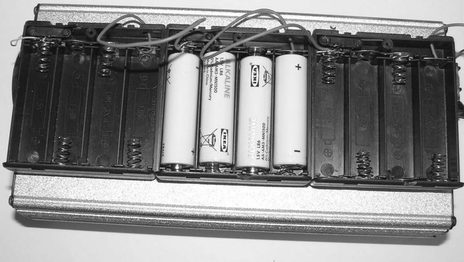
Рис. 3.30. Установка боксов для элементов питания на корпус адаптера-преобразователя
