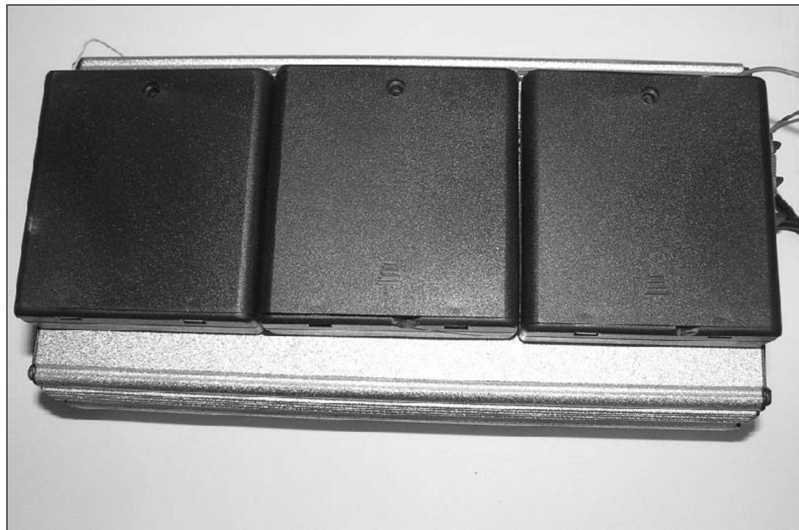
Рис. 3.32. Внешний вид готового автономного источника напряжения 220 В и мощностью 350 Вт
