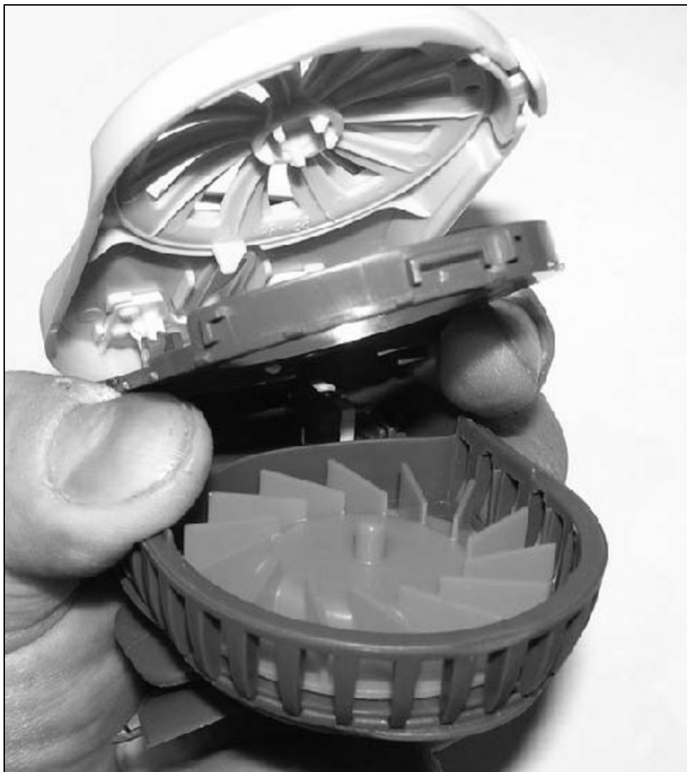
Рис. 3.22. Вид на устройство внутри фэн-системы
