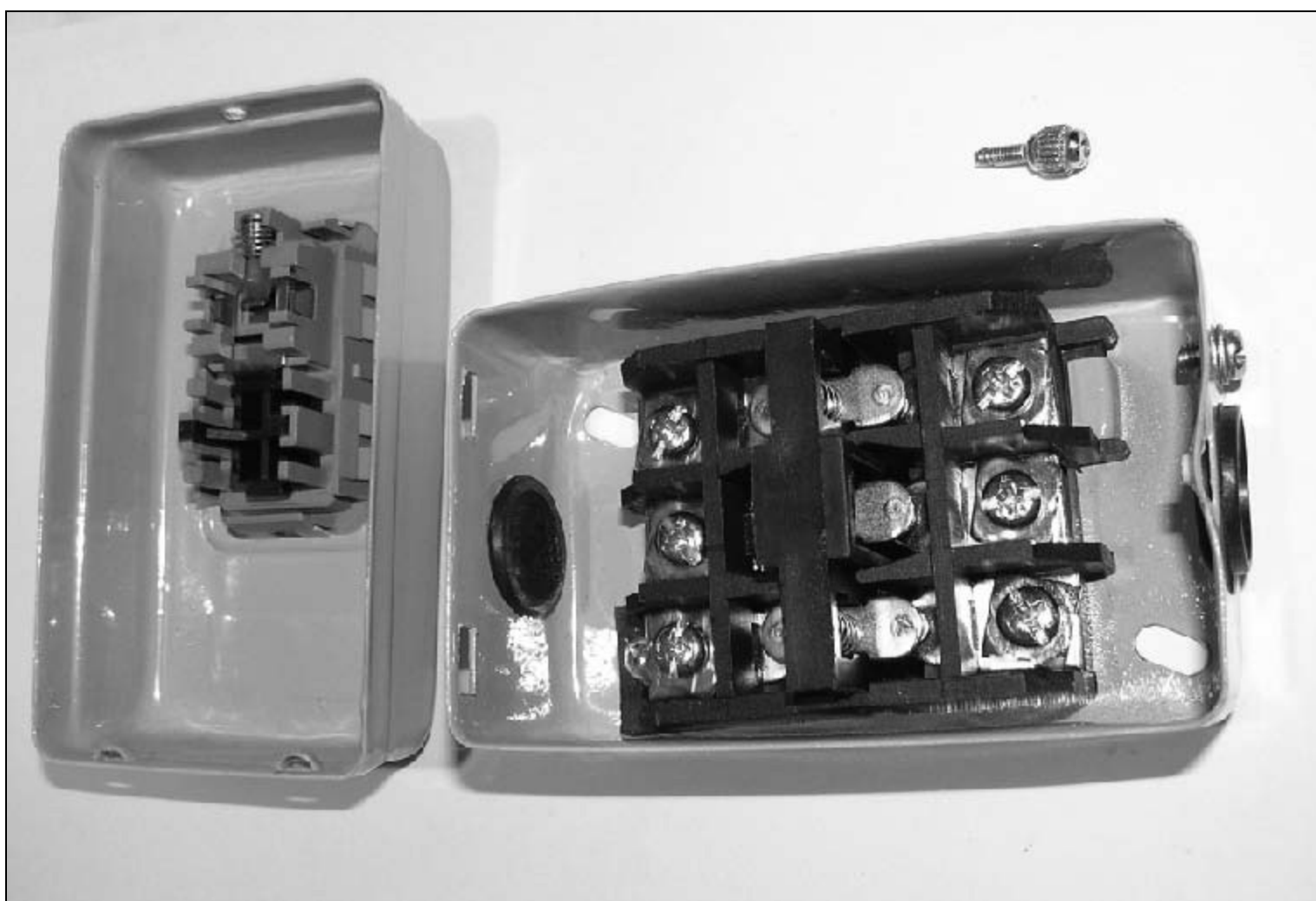
Рис. 1.39. Вид на внутренности другого корпуса «тревожной кнопки»
