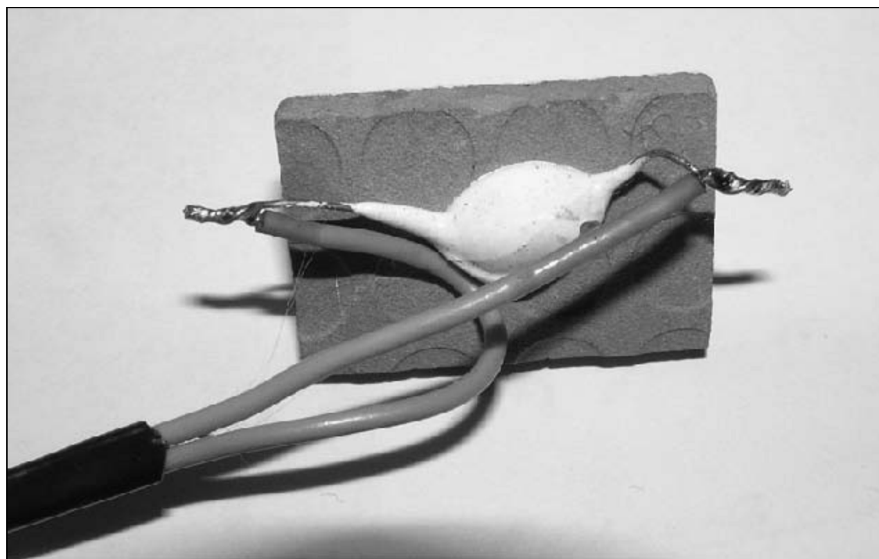
Рис. 1.3. Вид на приклеенный с тыльной стороны кафеля резистор R2
