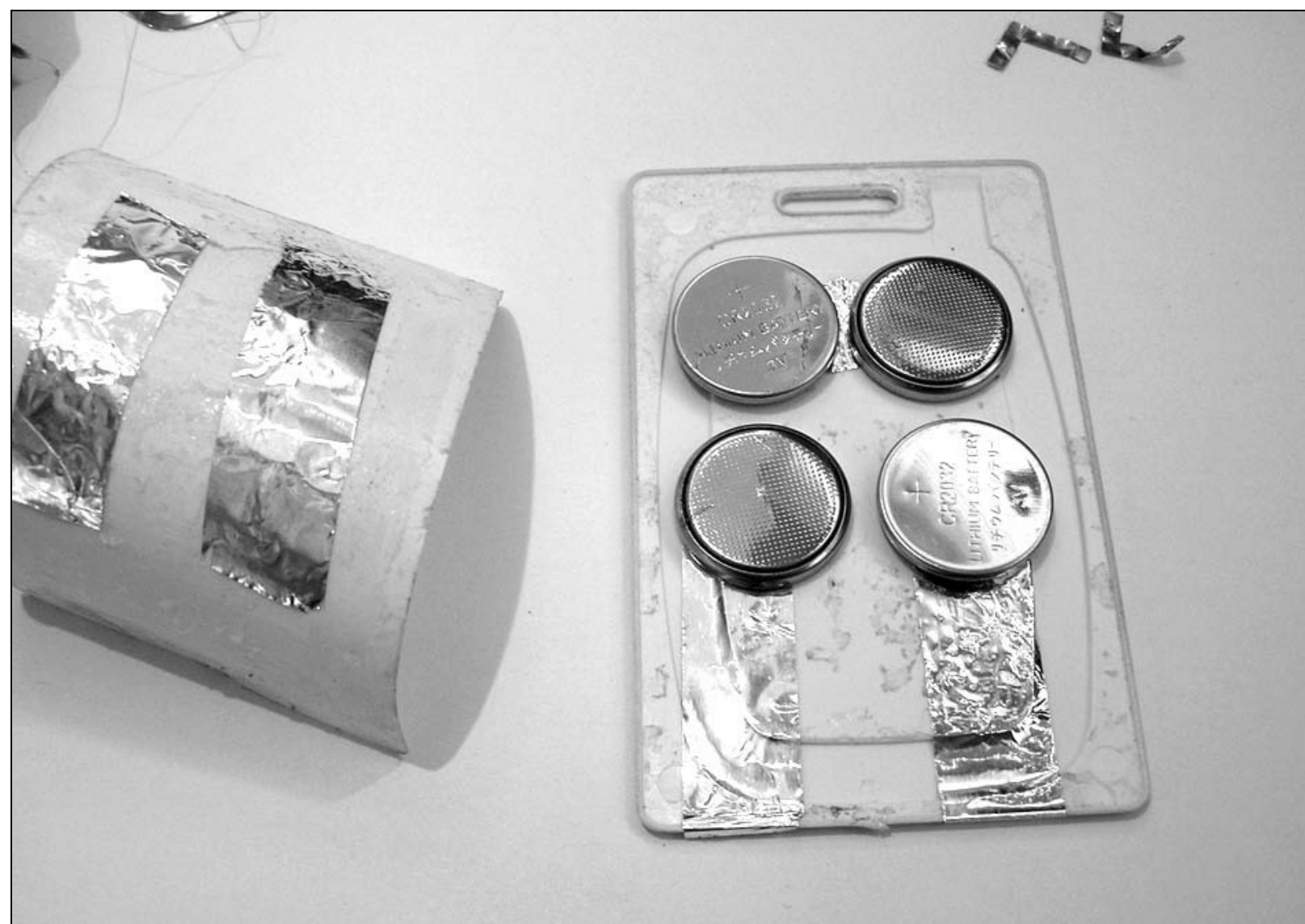
Рис. 1.27. Вид соединенных в последовательную цепь 4 элементов CR2032 с выводом контактов за пределы корпуса смарт-карты
