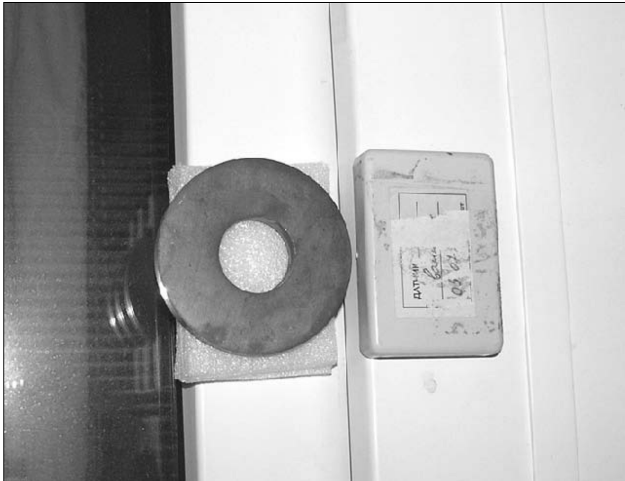
Рис. 1.33. Практическое размещение датчика на балконной двери в апартаментах автора
