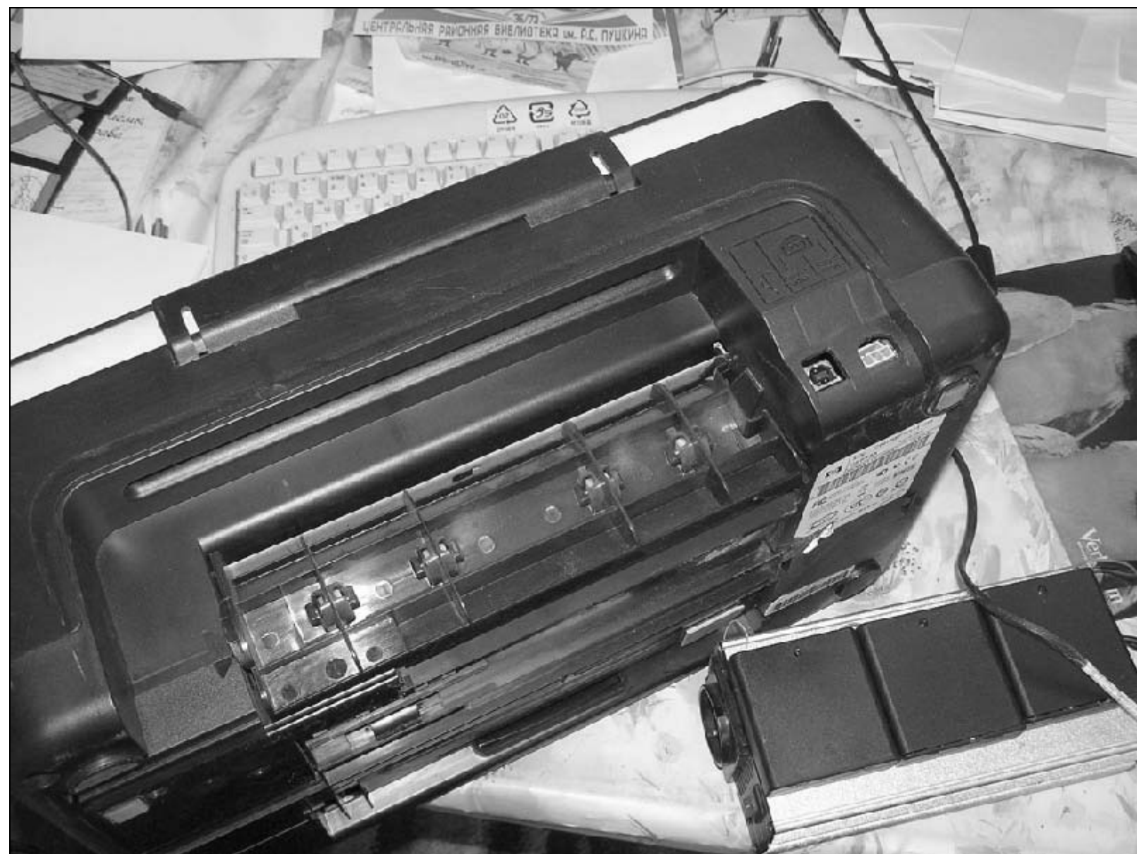
Рис. 3.28. Вид на заднюю стенку МФУ– разъемы подключения питания и соединительного кабеля от ПК
