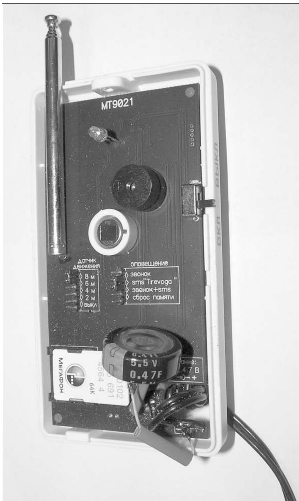
Рис. 1.54. Ионистор DB-5R5D474T, подключенный параллельно контактам разъема питания
