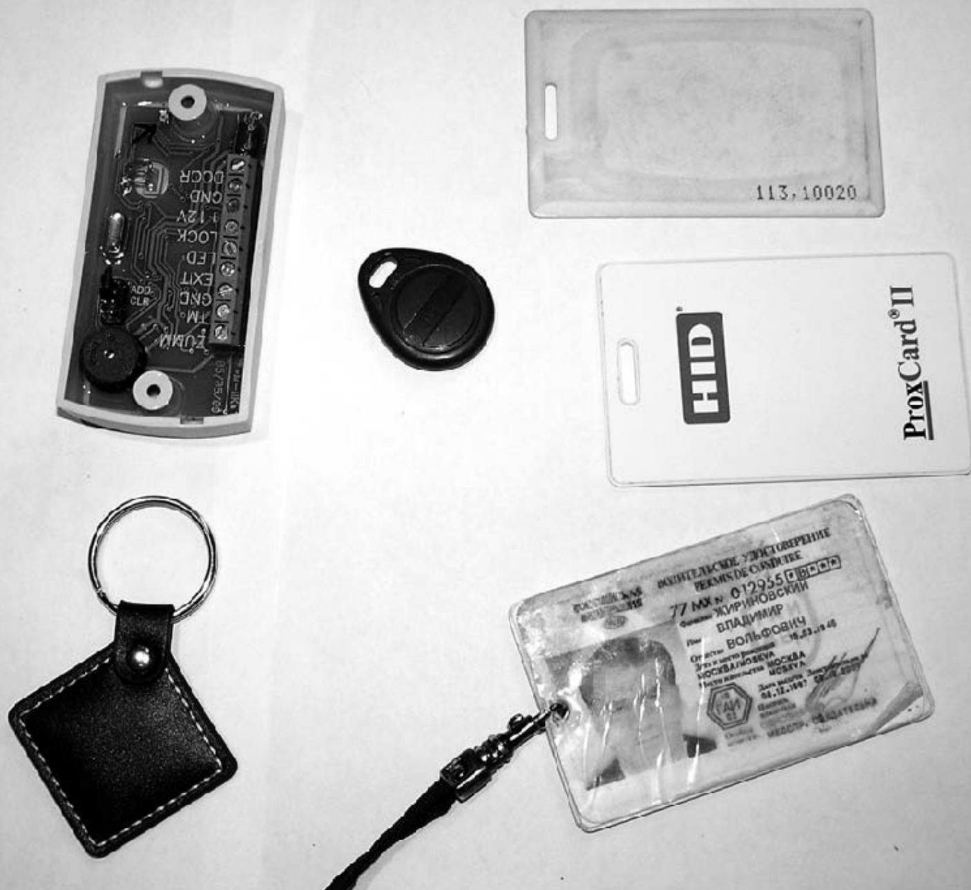
Рис. 1.23. Внешний вид бесконтактной идентификационной карты стандарта EM-Marine
