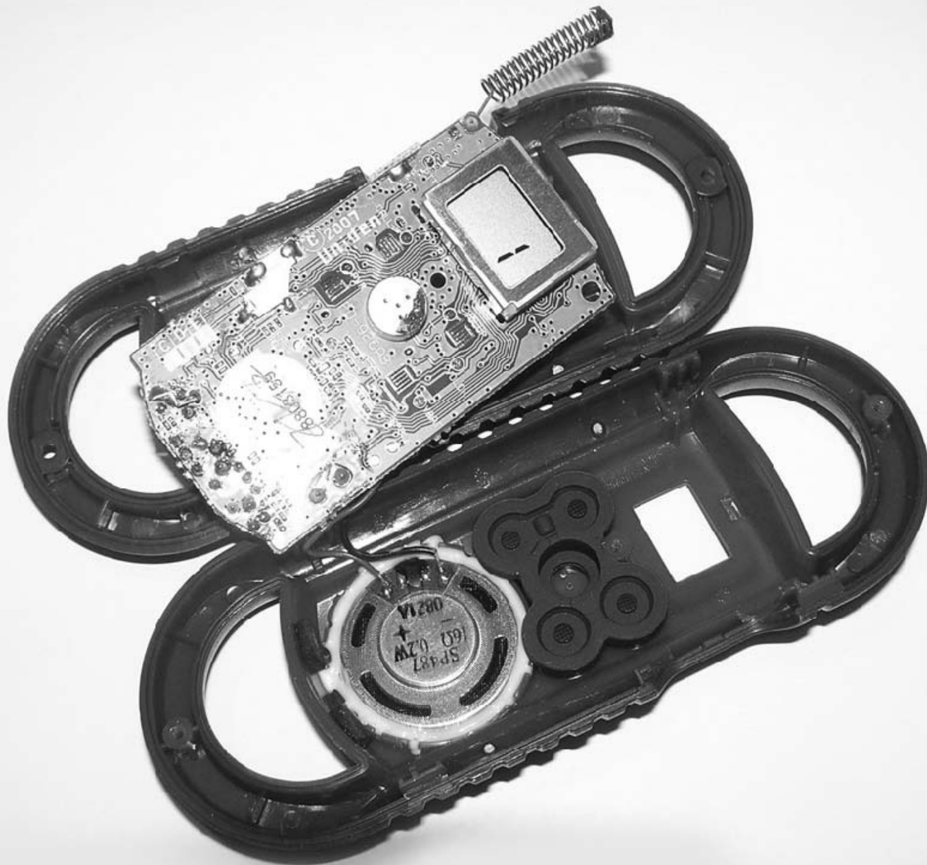
Рис. 3.10. Портативная радиостанция Motorola TLKR-T3 с раскрытым корпусом
