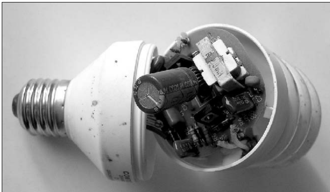
Рис. 2.20. Внешний вид платы ЭПРА (электронного балласта) из обычной энергосберегающей лампы с цоколем E27
