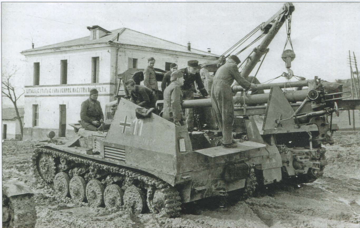
Монтаж орудия с помощью крана-тягача Sd.Kfz. 9/1. Италия, 1944 г.
