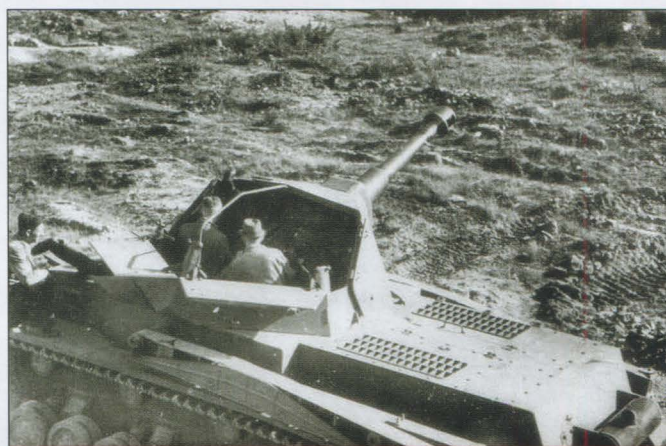
Башня 10,5 cm leFH 18/1(Sf) auf Geshützswagen IVb (Sd.Kfz. 165/1) могла поворачиваться на 35 градусов в каждую сторону и была открыта сверху
