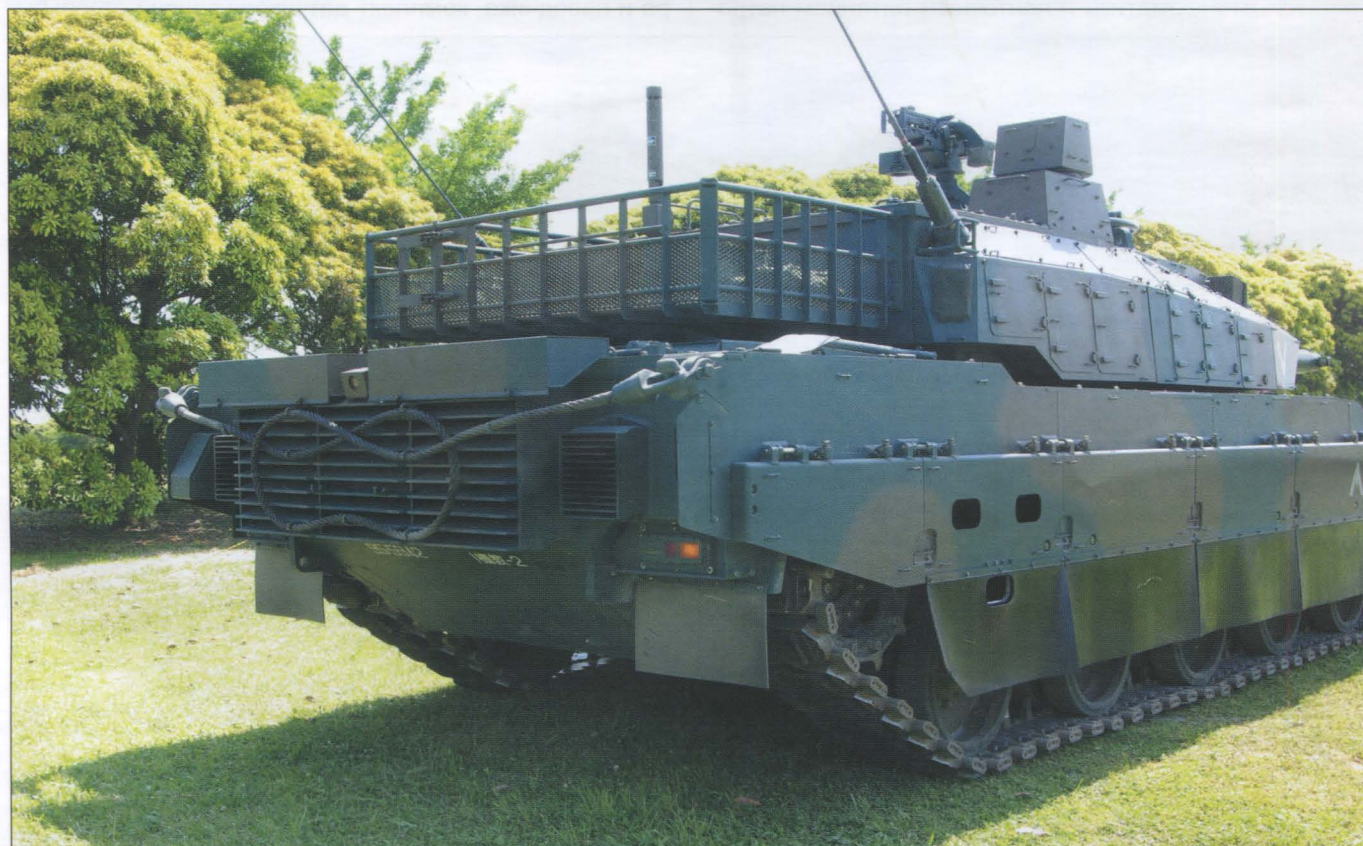
Танк «Тип 10», вид справа-сзади. Обратите внимание на зазор между башней и крышей моторно-трансмиссионного отделения. Фото Los688
