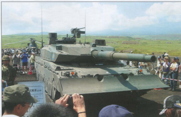
Для решения инженерных задач танк может оснащаться специальным бульдозерным отвалом. Фото Daddy178
