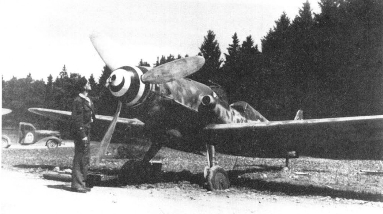
Истребитель Bf 109G-10 с мотором DB 605D (увеличенный воздухозаборник нагнетателя, характерный капот над мотором, широкие лопасти винта) и коком винта со спиралью
