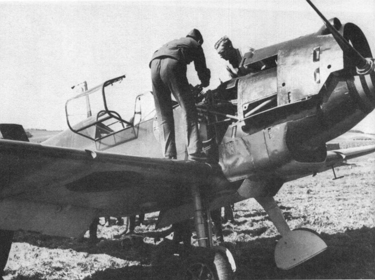
Конструкция Bf 109D-1 предполагала сдвигание вперед задней части капота мотора Jumo 210Da для обслуживания пулеметов
