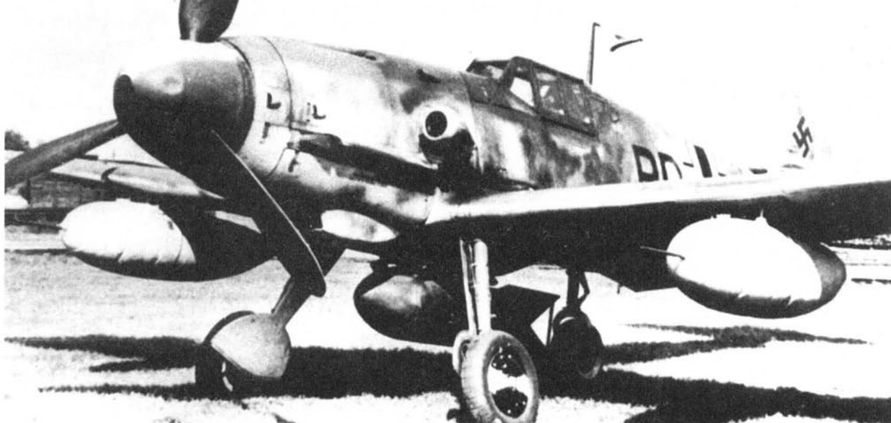
Необычный Bf 109G-2/R1 с двумя подкрыльевыми баками и бомбой SC 500 под фюзеляжем
