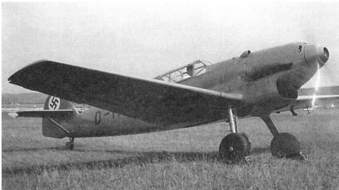
Прототип Bf 109V9 с мотором Jumo 210Ga и воздухозаборником маслорадиатора под мотором
