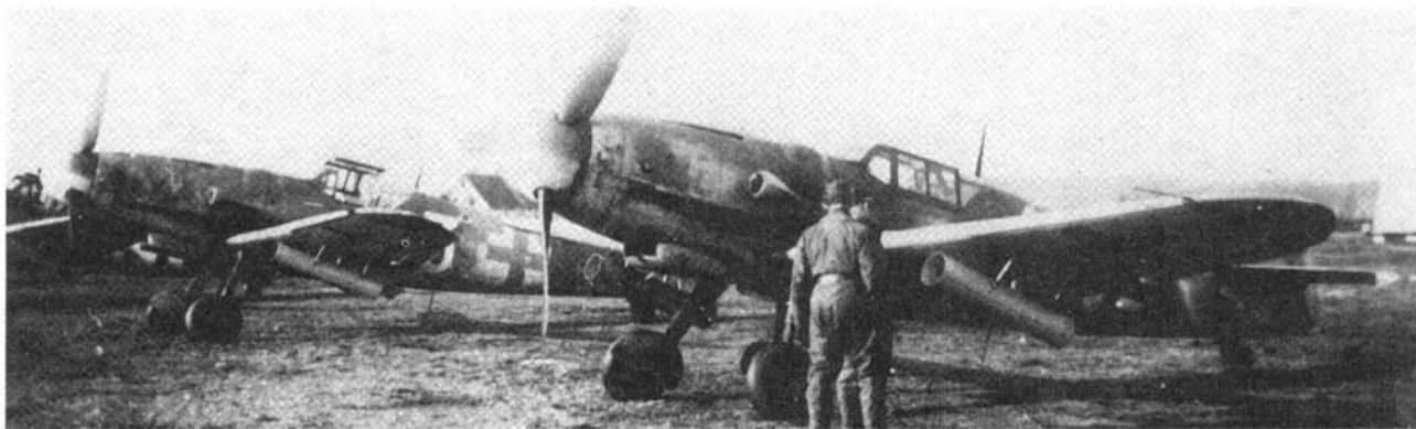
Истребители ПВО Рейха Bf 109G-6 с подвешенными под крылом пусковыми установками реактивных снарядов Wfr.Gr. 21
