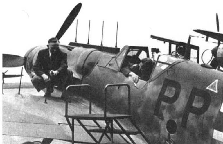
Экспериментальный Bf 109G-6 с антеннами радиолокатора «Нептун»
