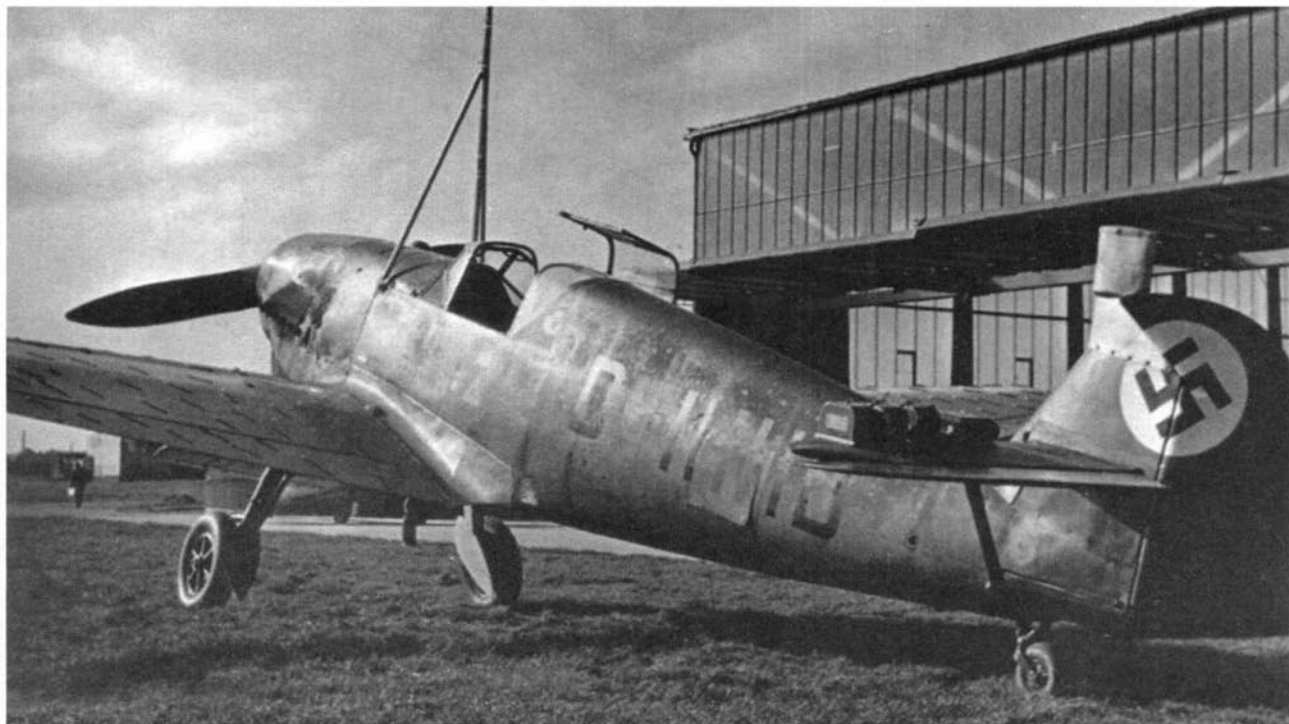
Прототип Bf 109V6 использовался для изучения аэродинамических особенностей машины. На крыло наклеены ленточки, над капотом — мачта с приемником воздушного давления
