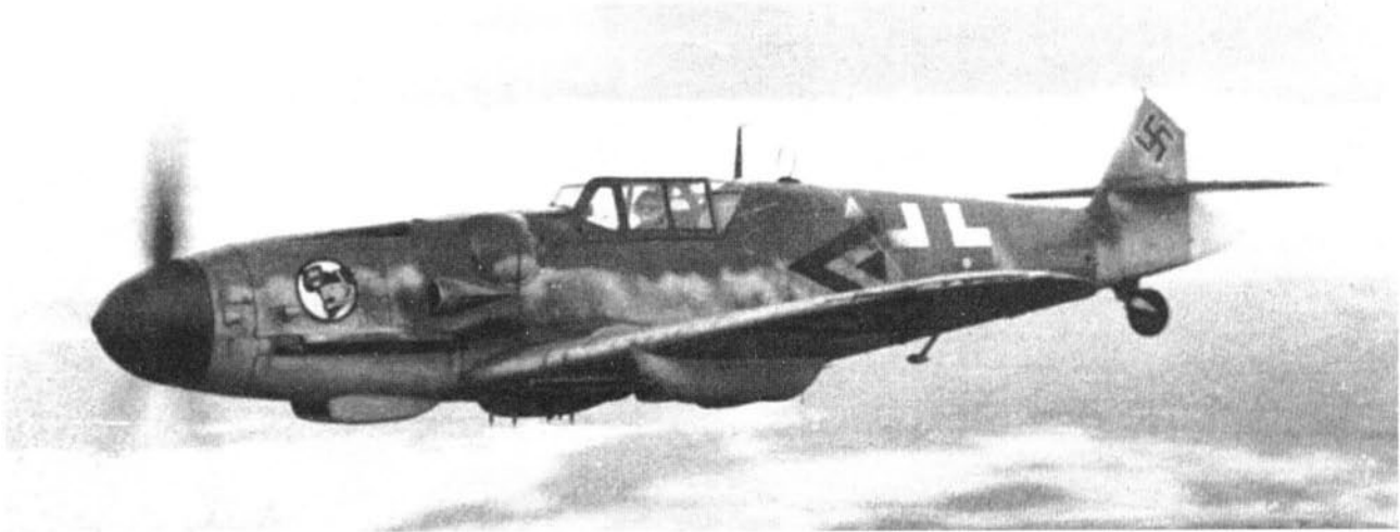
Самолет командира группы Bf 109G-6/R1/R6 с подфюзеляжным держателем и гондолами 20-мм пушек под крылом
