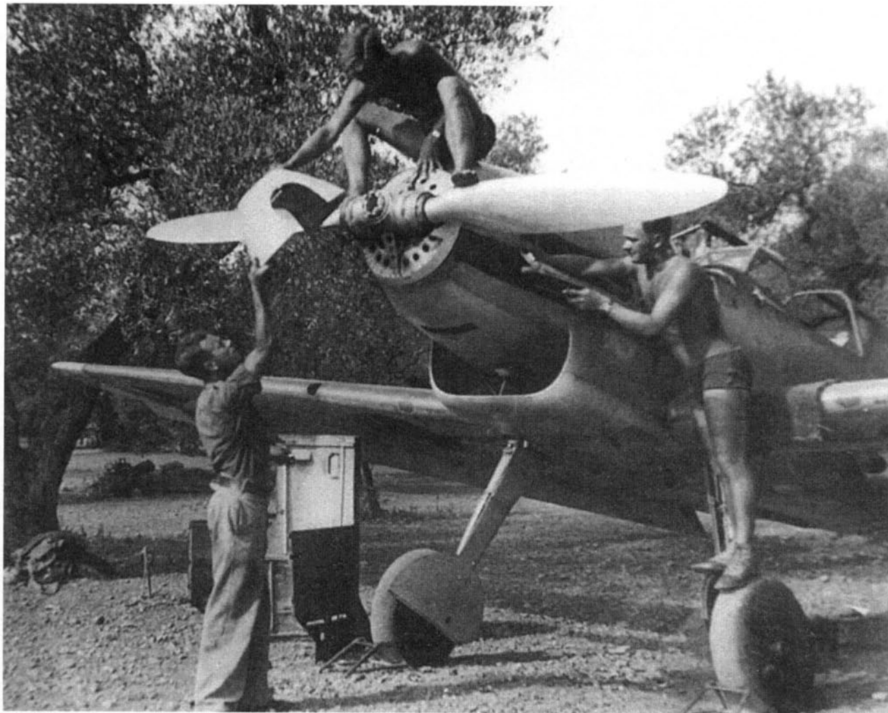
На серийных машинах Bf 109B-2 устанавливался двухшажный металлический винт, разработанный по лицензии фирмы «Гамильтон»
