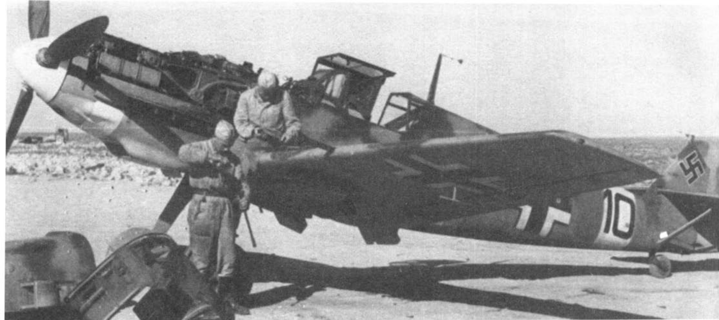
Обслуживание истребителя Bf 109E-7 из эскадры JG27. Характерное отличие — заостренный кок винта, нетипичный для ранних «Змийей»
