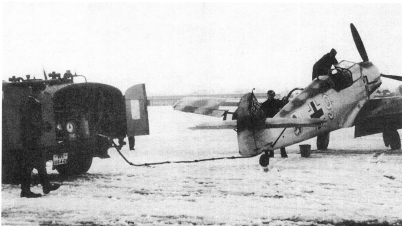
Заправочная горловина бензобака «мессершмитта» располагалась слева по полету позади фонаря кабины пилота. Готовится к вылету Bf 109E-1 из 2/JG76
