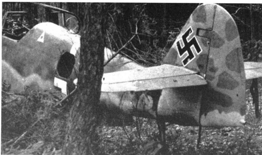
Брошенный в лесополосе на окраине аэродрома «Курфюст». Характерная особенность — удлиненная неубирающаяся хвостовая стойка шасси
