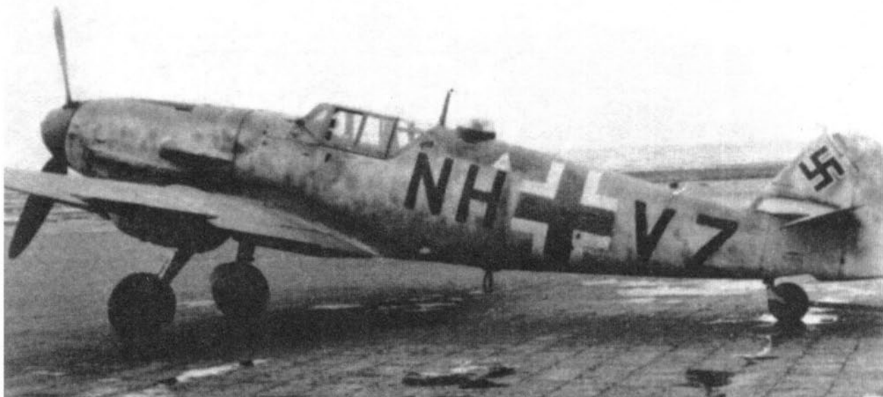
На этом Bf 109G-6 в закабинном отсеке под плексигласовым колпаком смонтирована антенна устройства «Наксос», регистрировавшего направление на излучение бортовых радиолокаторов английских и американских бомбардировщиков
