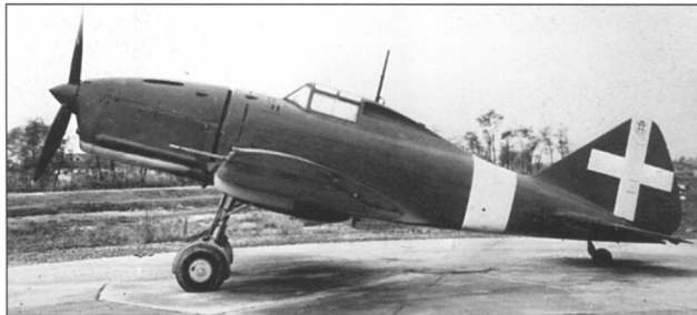
Re.2001 с мотором «Изотта-Фраскини» «Дельта»
