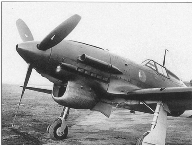
Macchi C.202d III серии (MM 7768) с модернизированным радиатором
