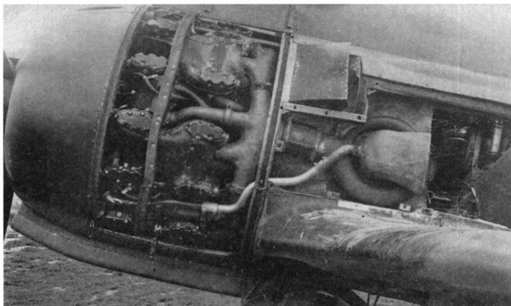
Установка турбокомпрессора ТК-3 на Ла-5ФТК, 1943 г.
