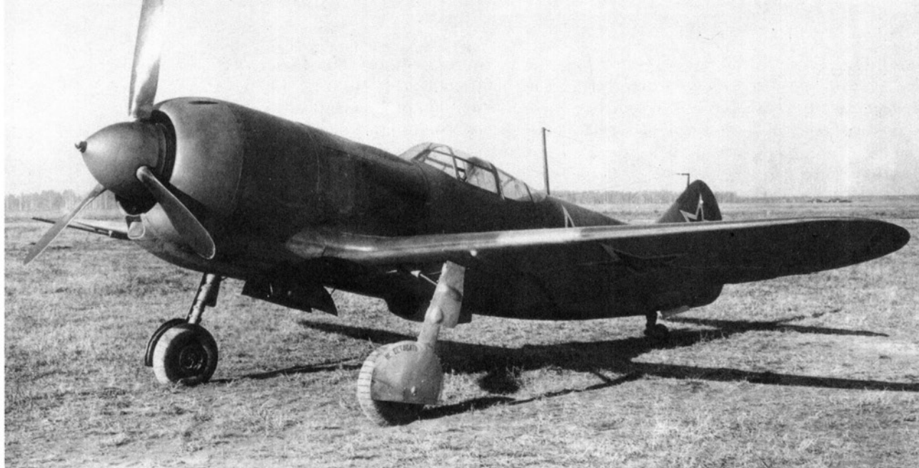
Модифицированный Ла-5ФН. На этом самолете были не только новый прицел и откидывающаяся вбок часть фонаря кабины пилота, но и смещенный вниз воздухозаборник, а также маслорадиатор, перенесенный под центроплан крыла
