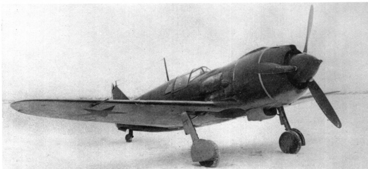
Ла-5 с герметизацией капота по рекомендации ЦАГИ
