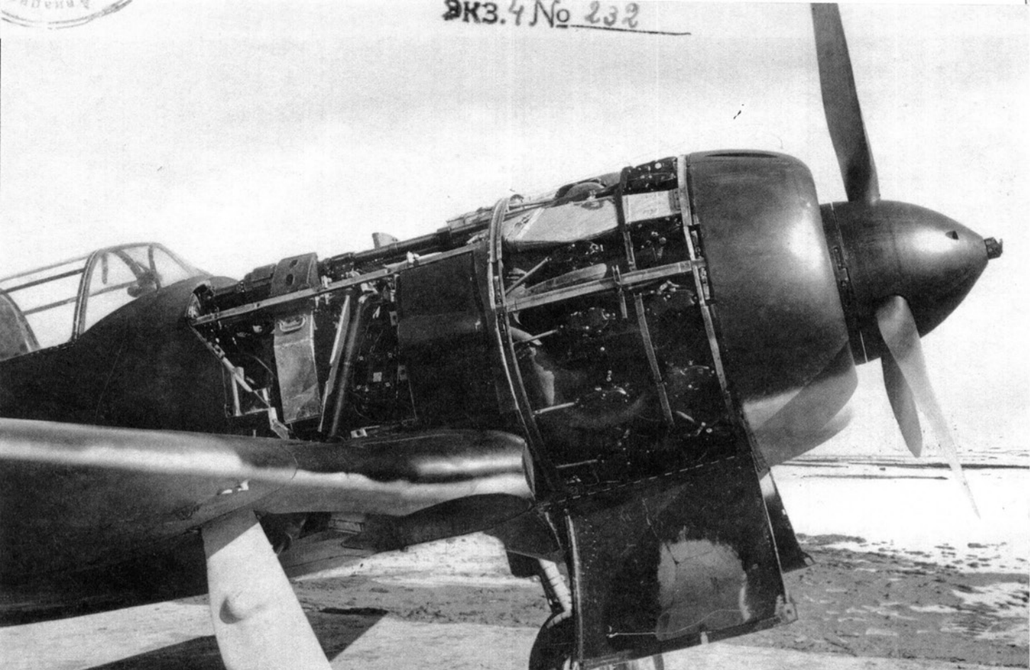
Силовая установка и вооружение самолета Ла-5
