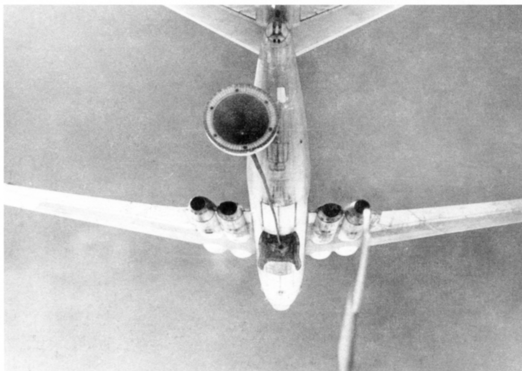
Выпуск топливо- заправочного шланга с самолета ЗМС-2
