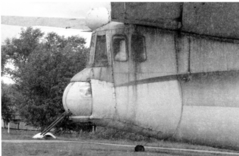
Кормовая артиллерийская установка М-4
