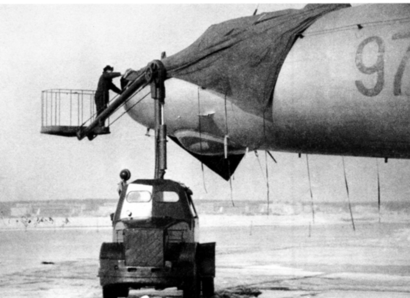
Чтобы зачехлить переднюю кабину М-4 требовался автоподъемник
