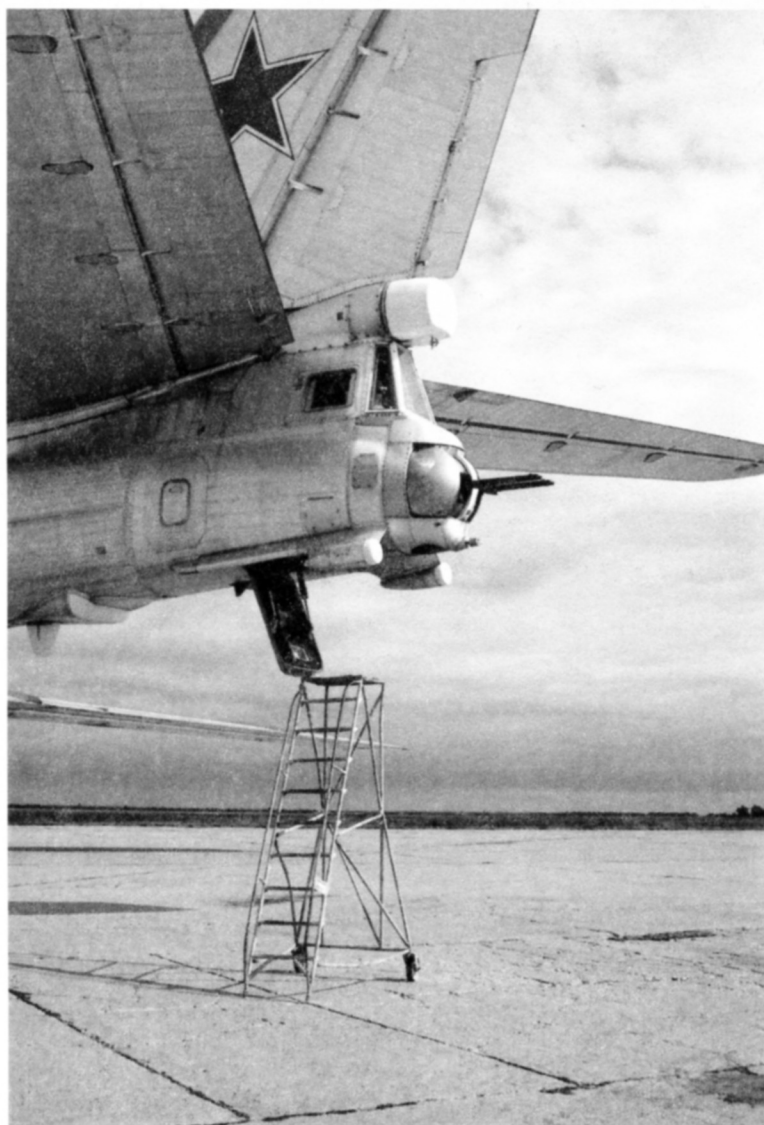
Кормовая артиллерийская установка с пушками ГШ-23Л самолета Ту-95МС
