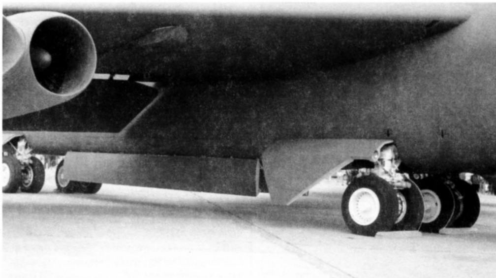
Шасси В-52Р и открытые створки грузового отсека
