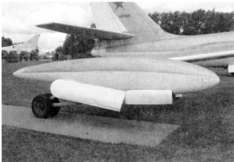
Крыльевая опора шасси самолета М-4
