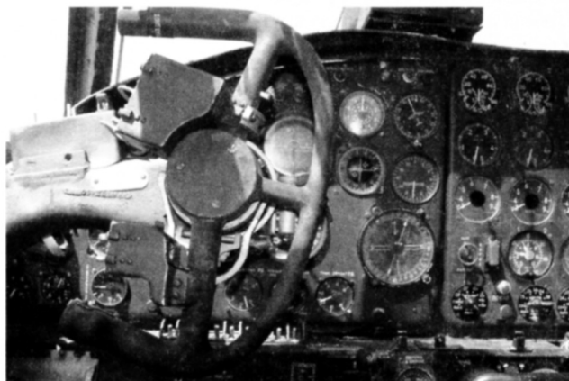
Фрагменты приборной доски летчиков самолета 3М
