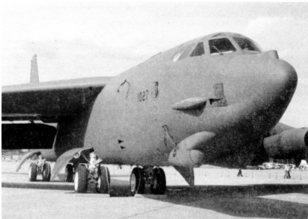
Под носовой частью фюзеляжа B-52H в ходе эксплуатации разместили датчики оптико-электронной системы EVS
