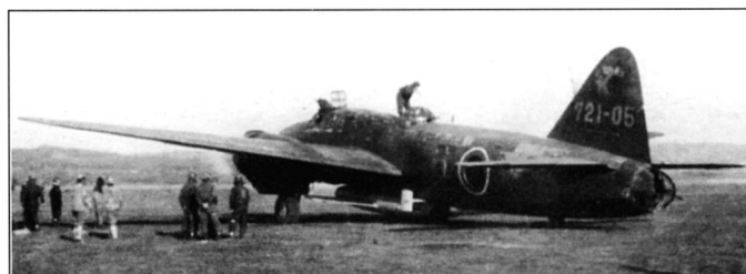
Подготовка к боевому вылету. Снаряд Ока подвешен под бомбардировщик Бэтти, принадлежащий 721 авиагруппе (см. номер на киле). Оружейники пополняют боезапас бортовых пулемётов
