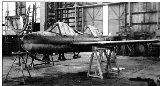
Учебный двухместный планёр Ohka K1 Kai. Видны: лыжа и предохранительная дуга на законцовке крыла. Фонари кабин имеют разную конструкцию: Задний фонарь сдвигается назад, а передний — просто снимается
