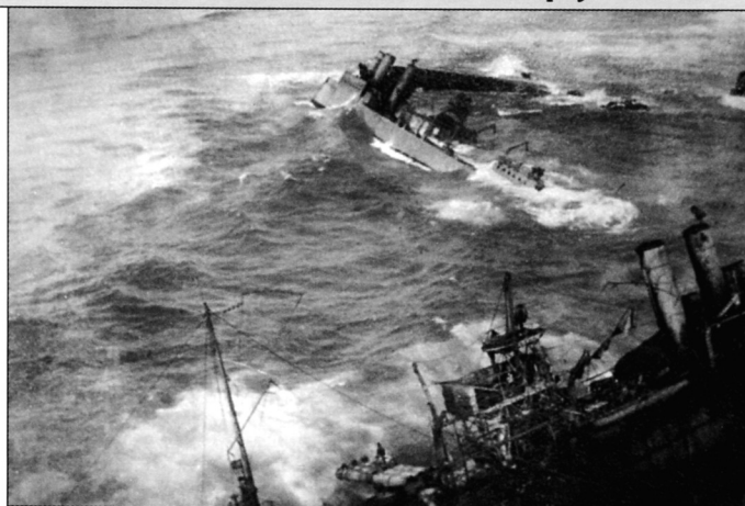
Два фото, сделанные по прошествии некоторого времени после катастрофы. «Николас» разломлен волнами на две части между первой и второй трубами. На переднем плане – корпус «С.П. Ли»
