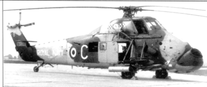
«Wessex» со смешанным вариантом подвески: две ПТУР SS.11 и два блока неуправляемых ракет. Кроме того на внешней подвеске за грузовой дверью машина несет противолодочную торпеду (верхнее фото)
