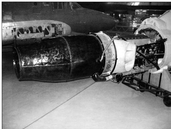
Мотокомпрессорный двигатель Tsu-11. Видны: Сопло и камера сгорания, воздуховод (белого цвета) и поршневой двигатель Хитахи GK4A. Из гаргрота торчат две тяги для приводов рулей на оперении
