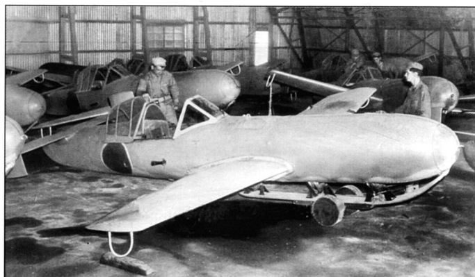
Учебные планёры Ока K1 в ангаре. Видны: посадочная лыжа, перекатные колёса, предохранительные дуги на законцовках крыла и трубка Вентури ниже фонаря, перед опознавательным знаком.
