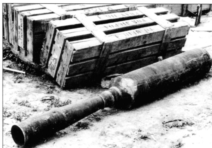
Твёрдотопливный двигатель Тип 4-1 Модель 20 имел тягу 266 кгс, которую развивал в течение 8...10 сек. Слева ящики, в которых двигатели поставлялись на фронт
