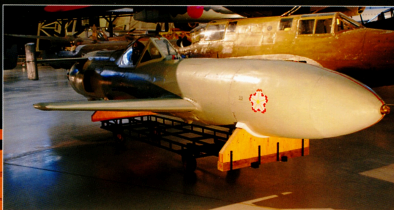
Музейная Ока мод. 22. На борту, ниже фонаря, установлена трубка Вентури
