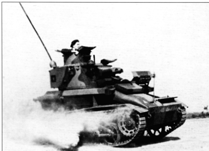
Mk.VIB с модернизированной ходовой частью
