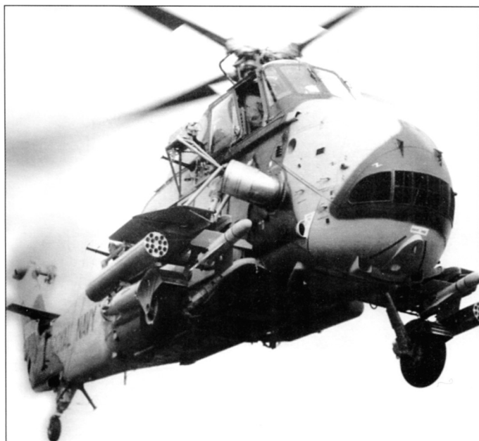
«Wessex» со смешанным вариантом подвески: две ПТУР SS.11 и два блока неуправляемых ракет. Кроме того на внешней подвеске за грузовой дверью машина несет противолодочную торпеду (верхнее фото)
