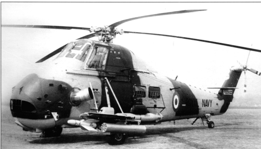
«Wessex» со смешанным вариантом подвески: две ПТУР SS.11, два блока неуправляемых ракет и контейнеры с пулеметами L20. На внешней подвеске за грузовой дверью машина несет противолодочную торпеду
