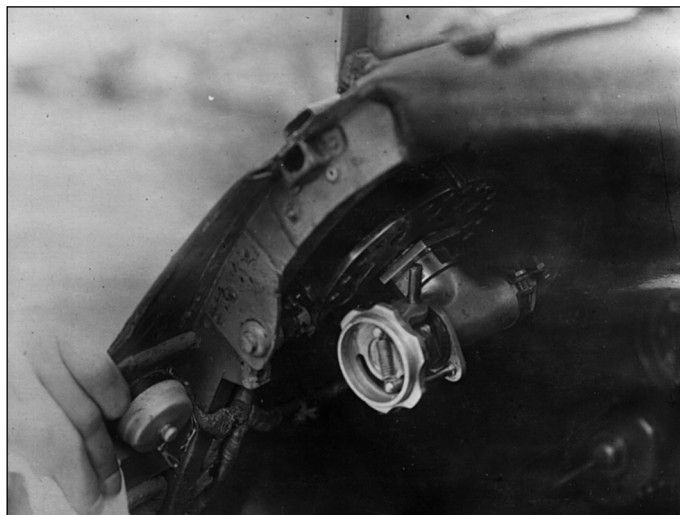
Специальный кран на левом борту в кабине И-16, перекрывающий подачу бензина перед отцеплением истребителя от носителя
