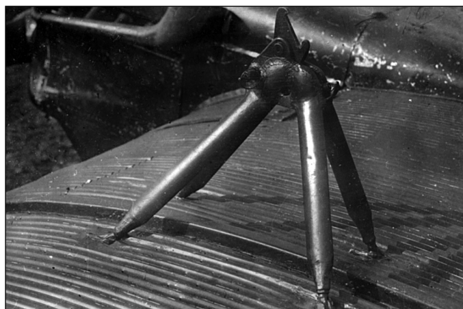
Одна из передних пирамид на крыле ТБ-3 для крепления шасси истребителя И-5
