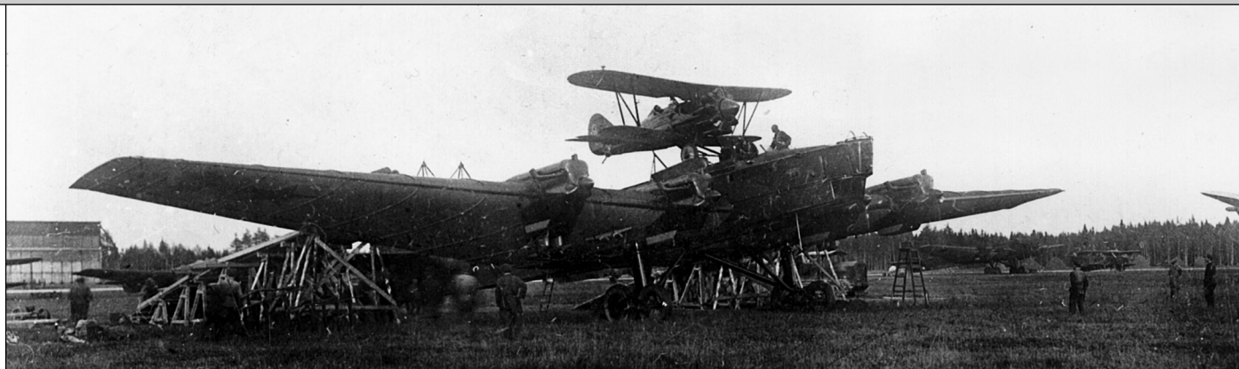
На представленных снимках за крылом ТБ-3 заметны две деревянные эстакады (рампы), по которым на пятиметровую высоту будут подняты и закреплены еще два истребителя И-5
