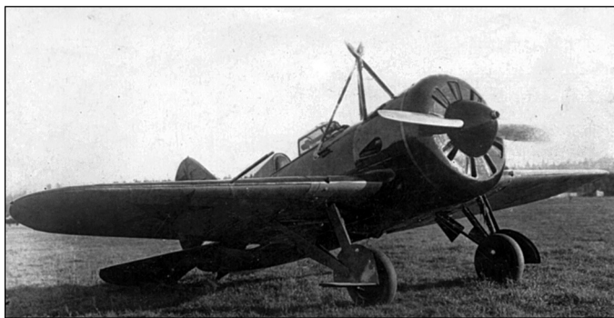
И-16 тип 5, оборудованный фермой с замком для подцепки
