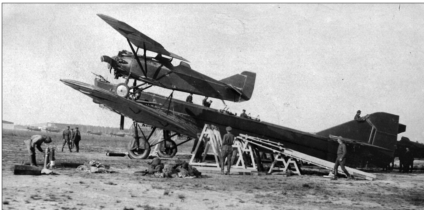
Левый истребитель установлен и закреплен на крыле ТБ-1
