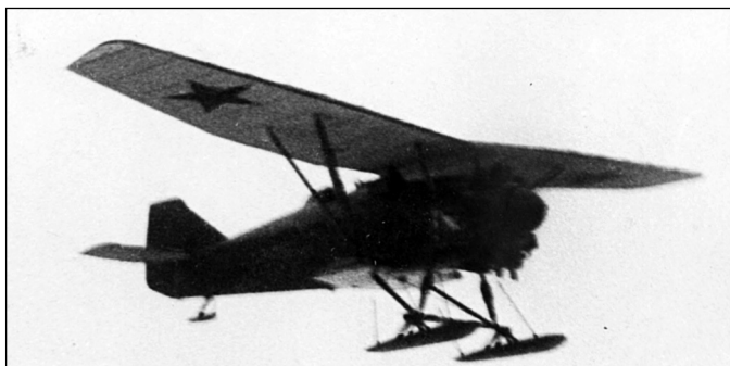
Истребитель охраны И-4 сопровождает бомбардировщик ТБ-1, с которого он стартовал в воздухе
