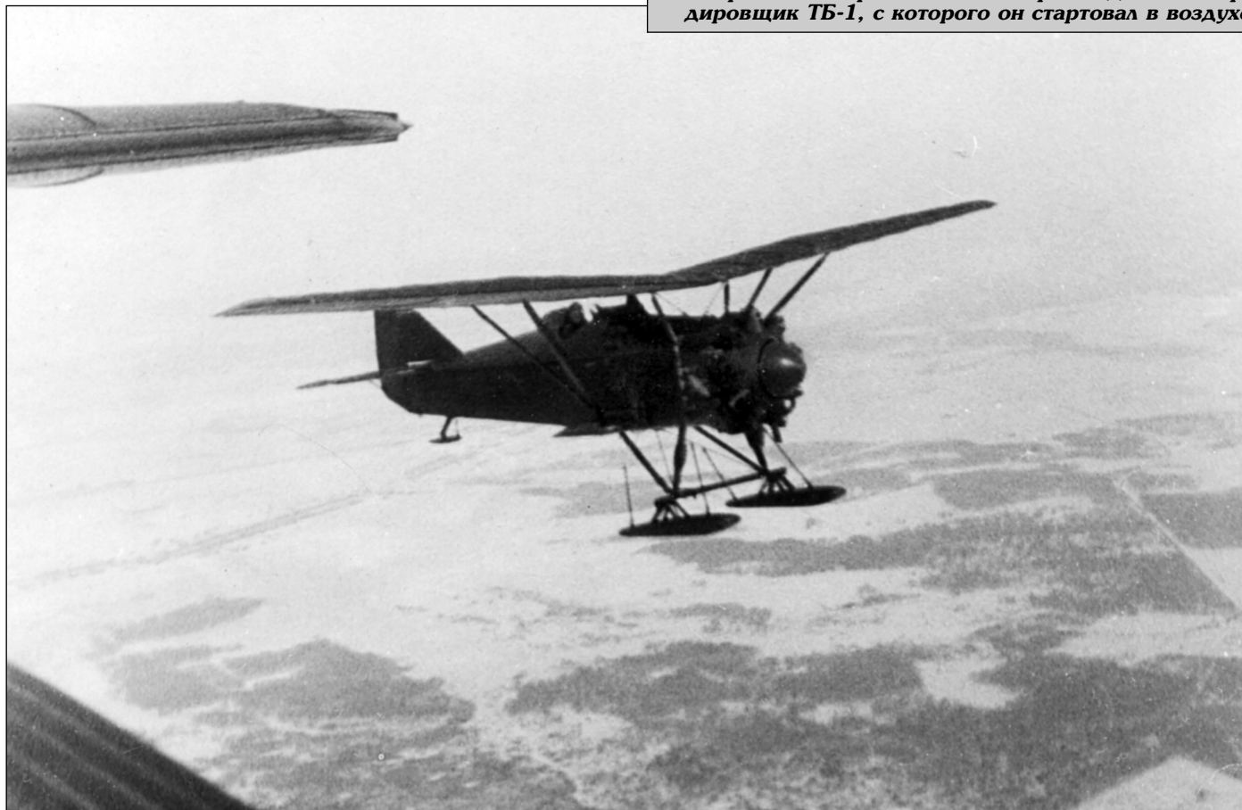
Истребитель охраны И-4 сопровождает бомбардировщик ТБ-1, с которого он стартовал в воздухе
