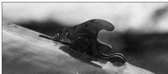
Хвостовой замок на фюзеляже И-16
