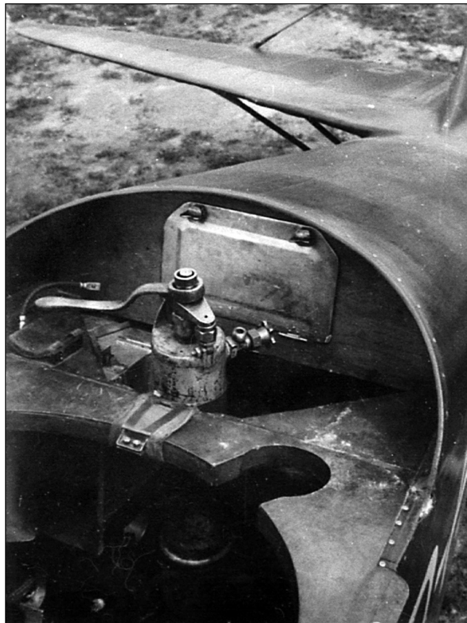
Установка одиночного цилиндра парашютно-тросовой пушки (ПТП) на самолете Р-3ЕТ с опознавательным знаком СССР-И189
