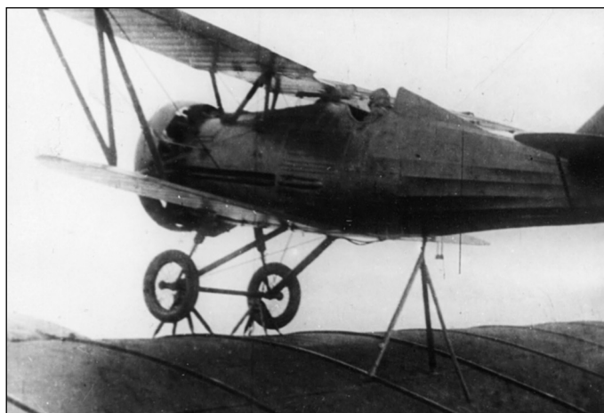
Истребитель И-5 на правом крыле ТБ-3 в ожидании воздушного старта
