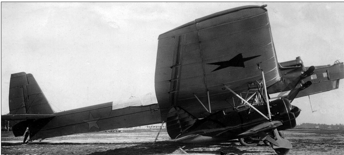
И-16 подцеплен и притянут под крыло ТБ-3. При последующей уборке шасси истребитель готов к совместному взлету с бомбардировщиком
