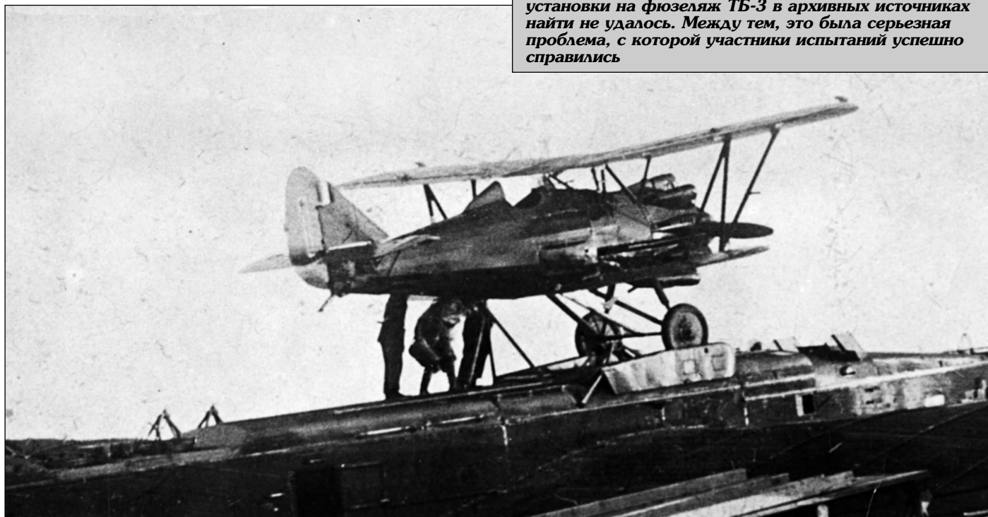
Задняя пирамида для закрепления фюзеляжа установлена в откинутом положении
