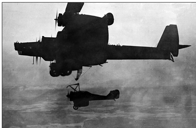
Оборудованный крюком истребитель И-ЗЕТ подходит под опущенную с ТБ-3 ферму подцепки
