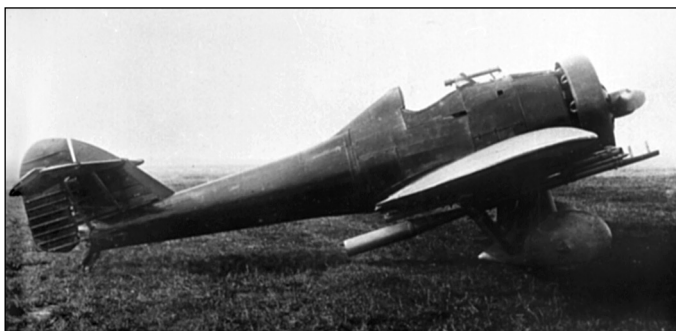
Общий вид истребителя И-ЗЕТ, вооруженного динамореактивными пушками Курчевского
