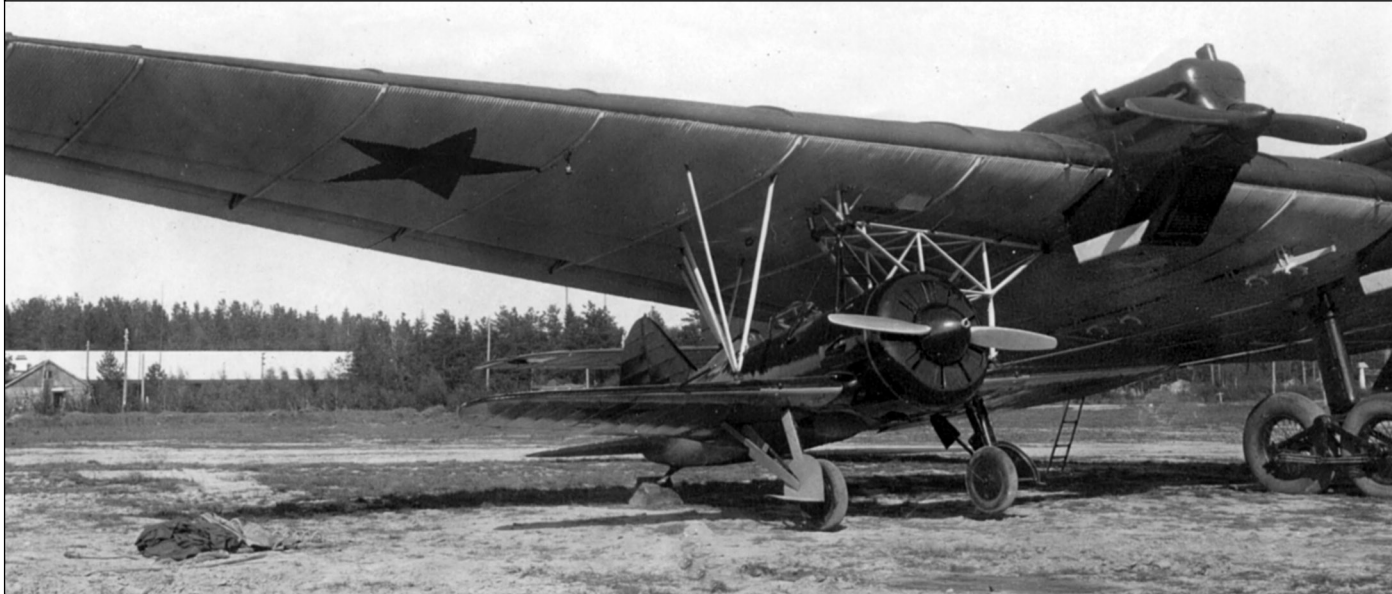
И-16 подцеплен и притянут под крыло ТБ-3. При последующей уборке шасси истребитель готов к совместному взлету с бомбардировщиком
