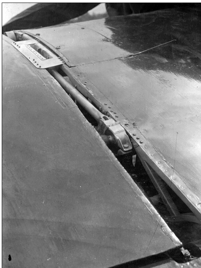
Вид на крыльевой замок, оборудованный в пространстве между центропланом и отъемной частью крыла И-16
