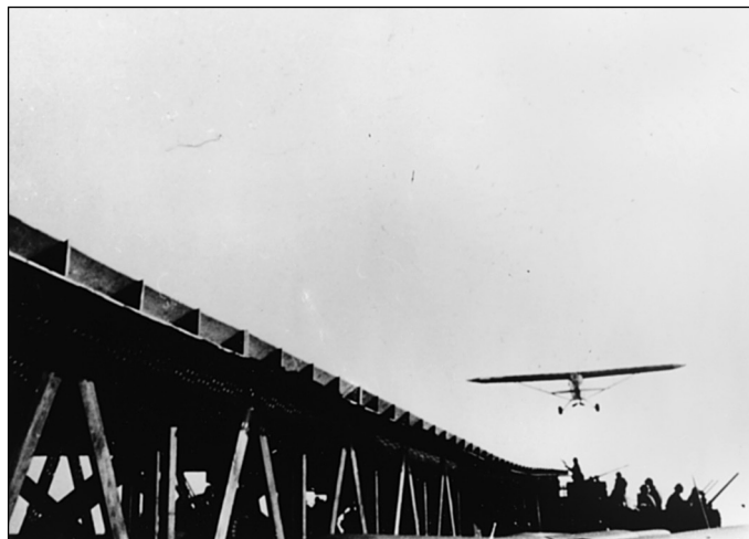
LST-16 во время высадки в Анцио (январь 1944 г.) Хорошо видна конструкция полетной палубы
