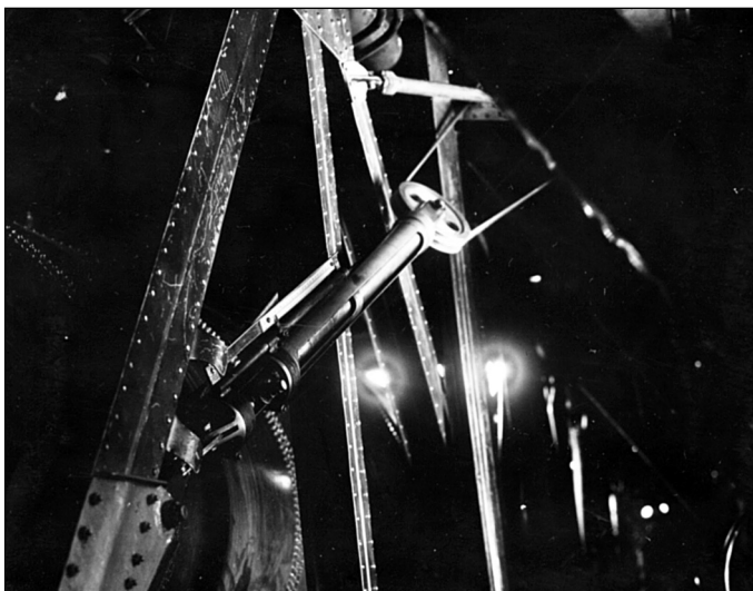
Размещенный в крыле ТБ-3 пост «оператора», управляющего подтягиванием И-16 к бомбардировщику
