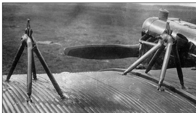
Пирамиды крепления истребителя И-5 на левом крыле бомбардировщика ТБ-3
