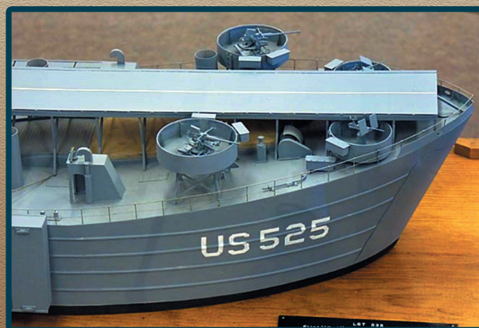
Модель танкодезантного корабля LST-525, оснащенного взлетной палубой
