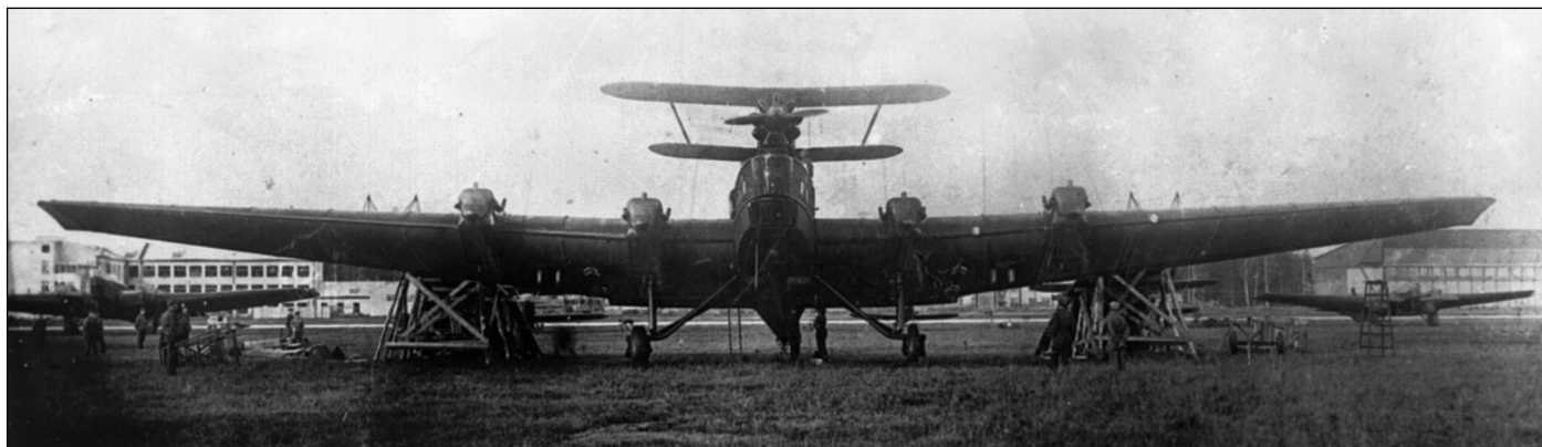
На представленных снимках за крылом ТБ-3 заметны две деревянные эстакады (рампы), по которым на пятиметровую высоту будут подняты и закреплены еще два истребителя И-5
