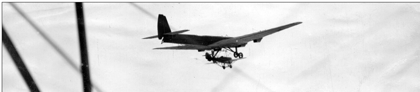
И-3ЕТ закреплен под бомбардировщиком
