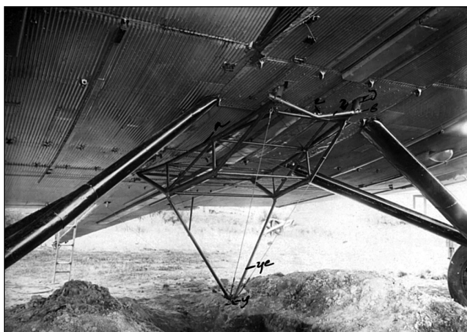
Опускаемая ферма под фюзеляжем ТБ-3 предназначалась для подцепления И-ЗЕТ. При отработке опускания и подъема фермы во время наземных испытаний устройства пришлось выкопать в земле канаву
