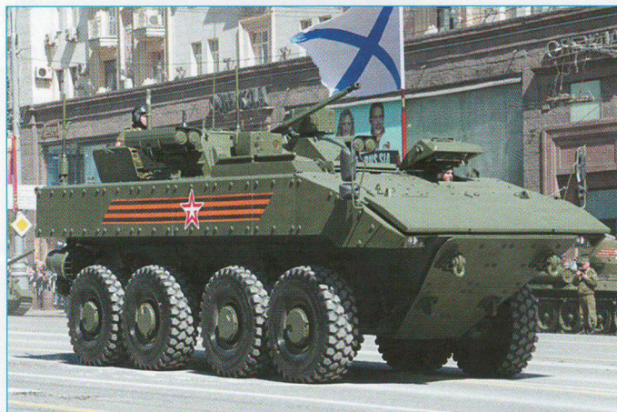
«Бумеранг» на Тверской улице перед генеральной репетицией парада. Москва, 7 мая 2015 года. Хорошо видны прицелы наводчика и командира, а также правая ПУ ПТУР «Корнет»
