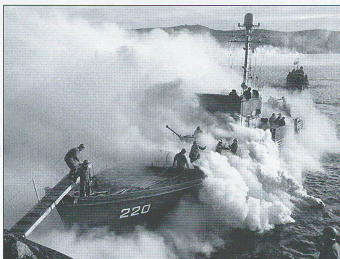
Полученный по ленд-лизу большой охотник за подводными лодками БО-220 типа SC. На топе мачты установлена антенна РАС SF-1. Северный флот, 1944 г.
