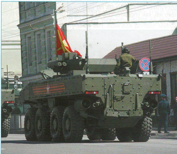
«Бумеранг» после репетиции. Хорошо видны дверь и откидная аппарель в кормовом листе корпуса
