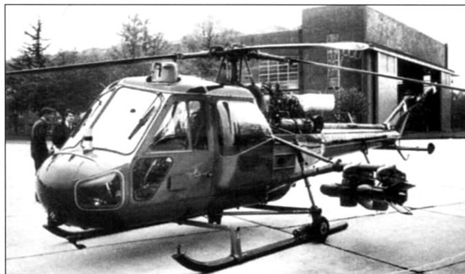
Вертолет «Скаут», оснащенный ПТУР SS-11. Хорошо видна следящая часть прицела AF.120, возвышающаяся над пилотской кабиной
