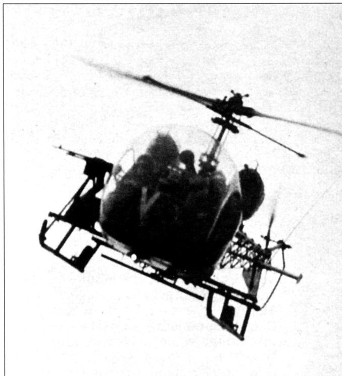
«Сиу» в полете. Хорошо видна пулеметная установка
