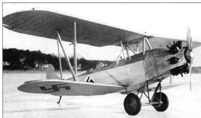
Учебно-тренировочный самолет «Свенска Аэро» SA-10 8-й (морской) АЭ на колесном и поплавковом шасси
