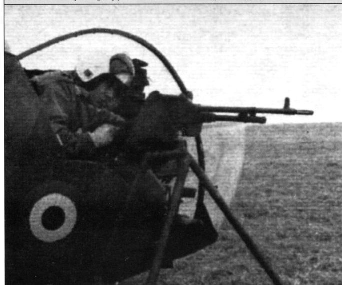
Варианты размещения пулеметов на «Сиу» в неподвижной (вверху) и подвижной (внизу) установках
