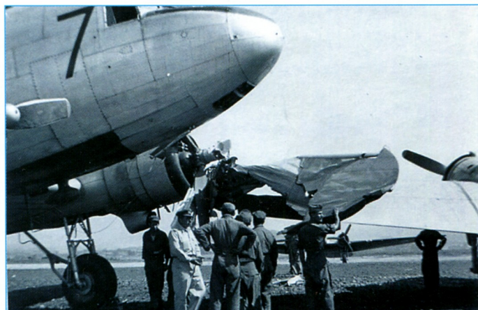
Что будет, если после смены колеса не снять консервационную смазку с тормозов... Авиабазы К-16, 1952 г.
