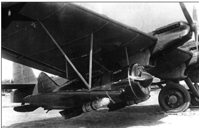
И-16 из 32-го иап ВВС ЧФ с двумя ФАБ-250, подвешенный под крылом самолета-носителя ТБ-3РН
