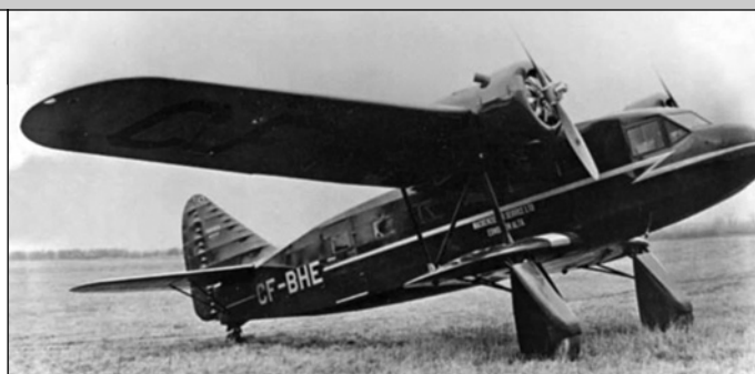
«Секани» проходил испытания как на поплавковом (вверху), так и на колесном (внизу) шасси
