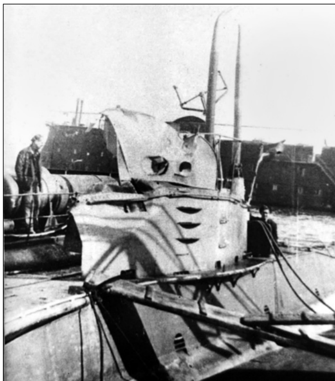
Повреждения подводной лодки «U-20» после столкновения с крейсером «Адмирал Шпаун»
