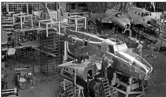
Сборка S.13 на заводе Амстердам-Норд. На заднем плане в правом углу виден один из двух макетов
