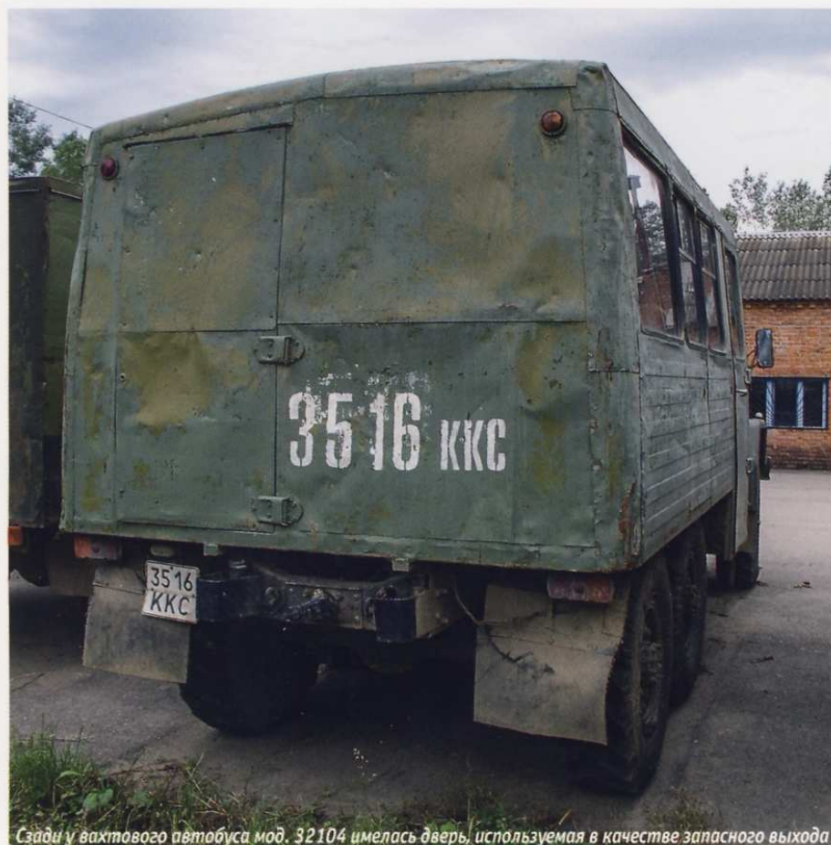
Сзади у вахтового автобуса мод. 32104 имелась дверь, используемая в качестве запасного выхода
