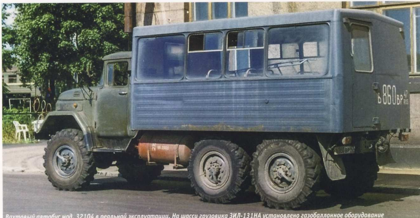
Вахтовый автобус мод. 32104 в реальной эксплуатации. На шасси грузовика ЗИЛ-131НА установлено газобаллонное оборудование
