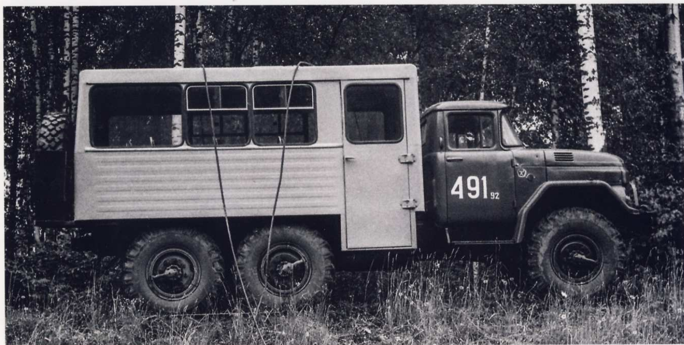
«Вахтовка» мод. 32104 на верхней кромке уклона перед испытанием переворотом. Хорошо видны тросы, за которые автомобиль будет перевернут
