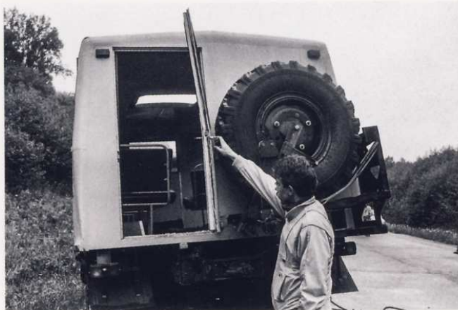
После полного переворота автобуса задняя дверь открылась без применения дополнительных средств
