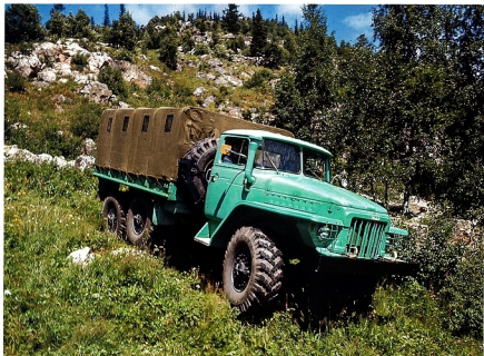
Цельнометаллическая кабина в итоге стала атрибутом серийных грузовиков «Урал-375Д»
