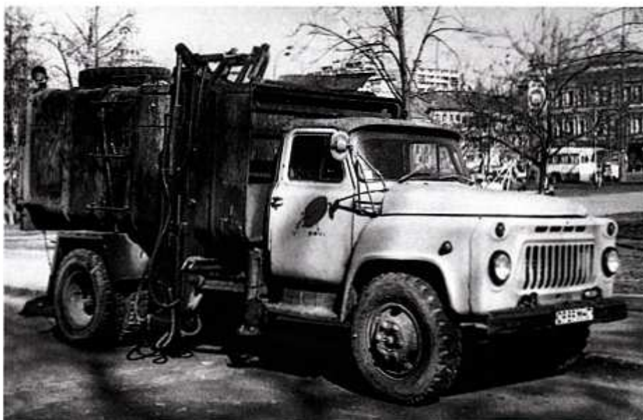
Первый массовый мусоровоз с механической перегрузкой контейнеров — КО-413 на шасси ГАЗ-53А
