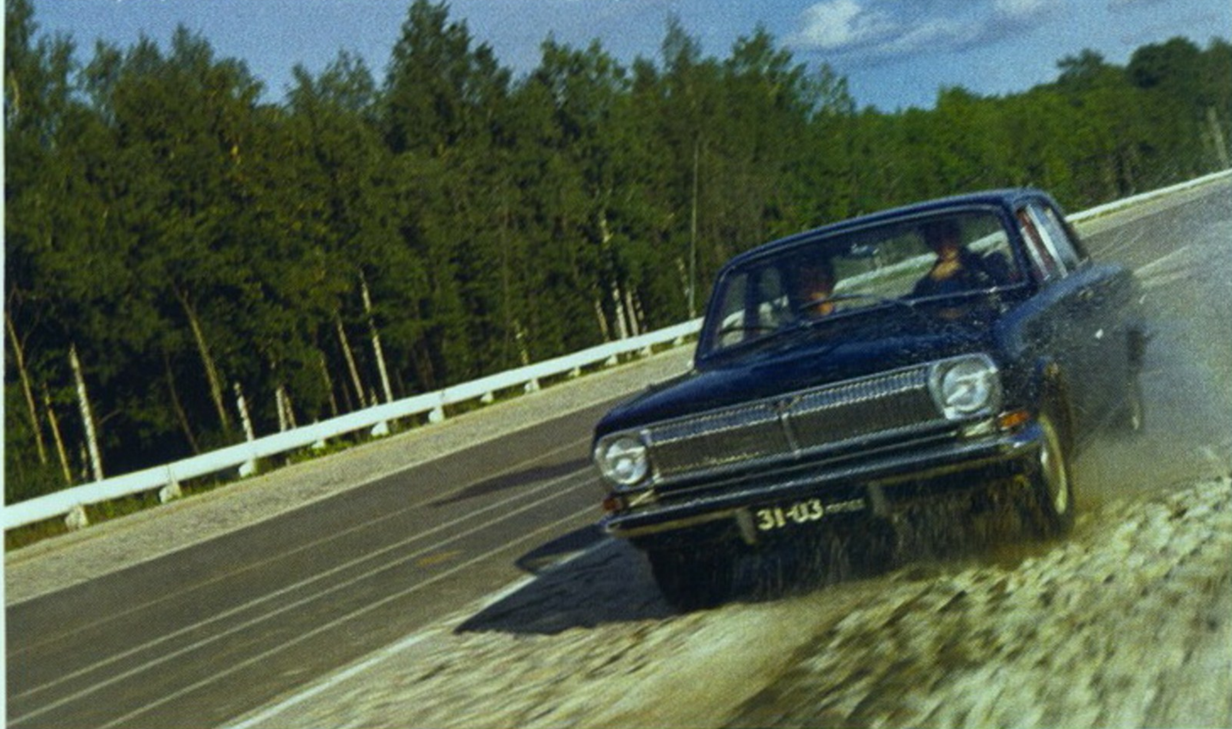
Опытный образец ГАЗ-24 «Волга»: испытания на автополигоне в Дмитрове
