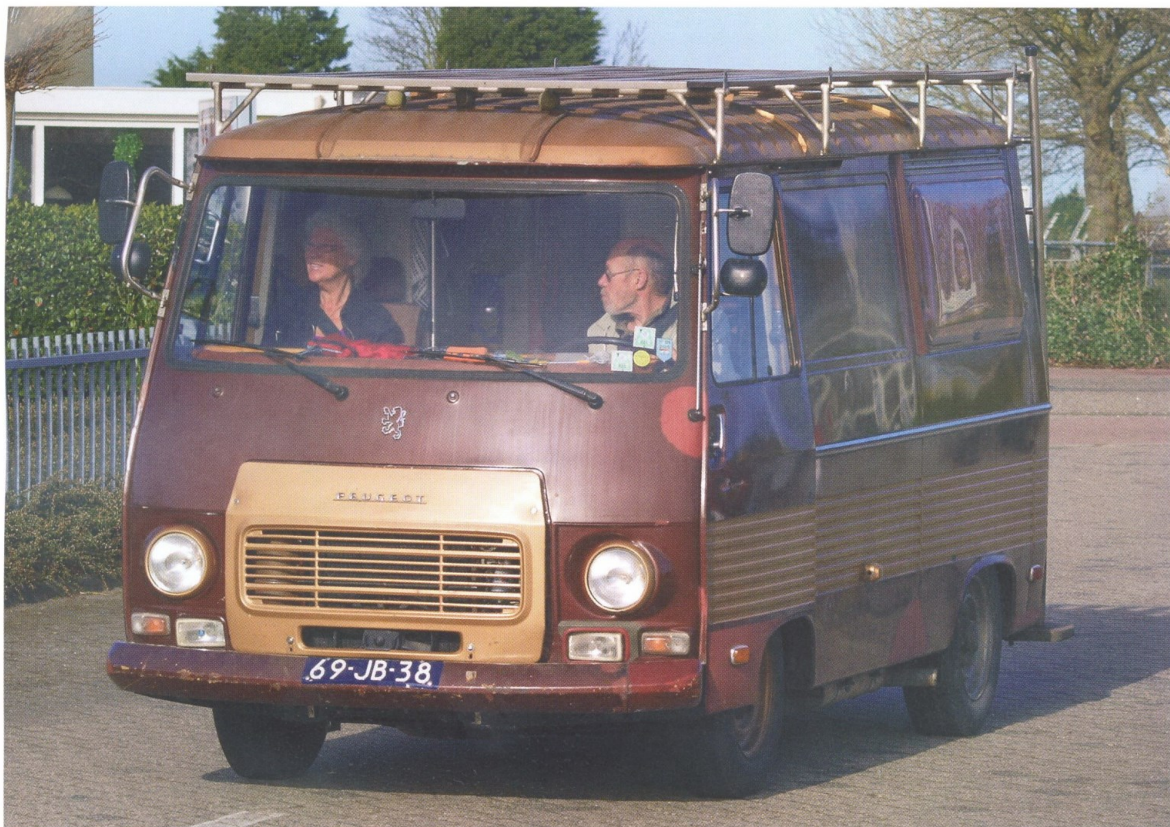
ЗА СЧЕТ ПАНЕЛЕЙ БОЛЬШОГО РАЗМЕРА КУЗОВ J7 БЫЛ ТАКИМ ЖЕСТКИМ, ЧТО НА КРЫШЕ МОЖНО БЫЛО УСТАНОВИТЬ ДОПОЛНИТЕЛЬНУЮ БАГАЖНУЮ ПЛАТФОРМУ
