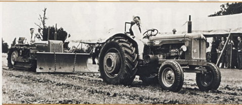
Для демонстрации мощи двигателя и сцепления с грунтом Power Major тащит гусеничный County Mk IV, также созданный на базе трактора Power Major.
