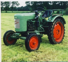
Поддрессоренная передняя ось и шесть передних передач позволяли F15 H6 маневрировать даже на пресеченной местности.
