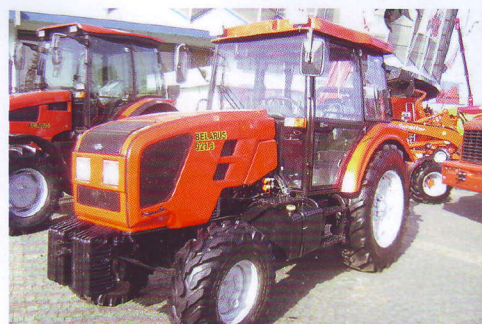
«Беларус-921» – полноприводный садоводческий колесный трактор тягового класса 1,4 – выпускается на Сморгонском тракторном заводе с 2000 года.
