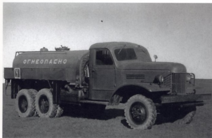
Бензовоз на шасси ЗИС-151, выполненный заводом «Сантехоборудование»
