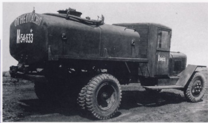
Бензовоз на шасси ЗИС-5, изготовленный заводом №25 НКВД
