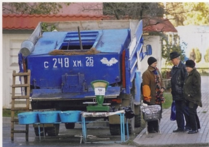
Самодельная цистерна для живой рыбы, установленная в кузове самосвала
