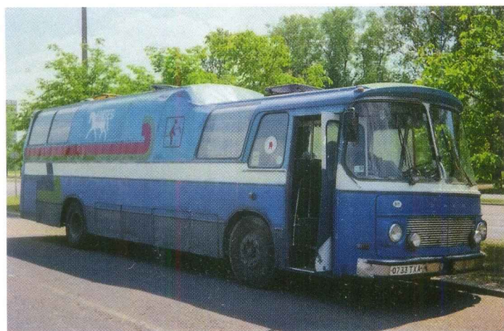
Междугородний автобус, переоборудованный под перевозку лошадей
