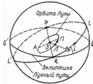
Рис. 52. Лунный путь ( LL' ) и лунная орбита ( АЛП ): З — Земля; Л — Луна в пространстве; С — видимое положение Луны на небе; наклонение l = 5^{\circ}09'
