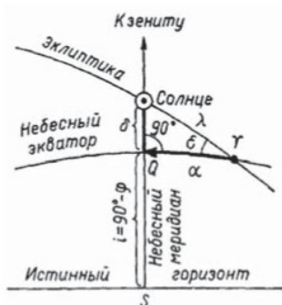
Рис. 20. Определение экваториальных координат Солнца
