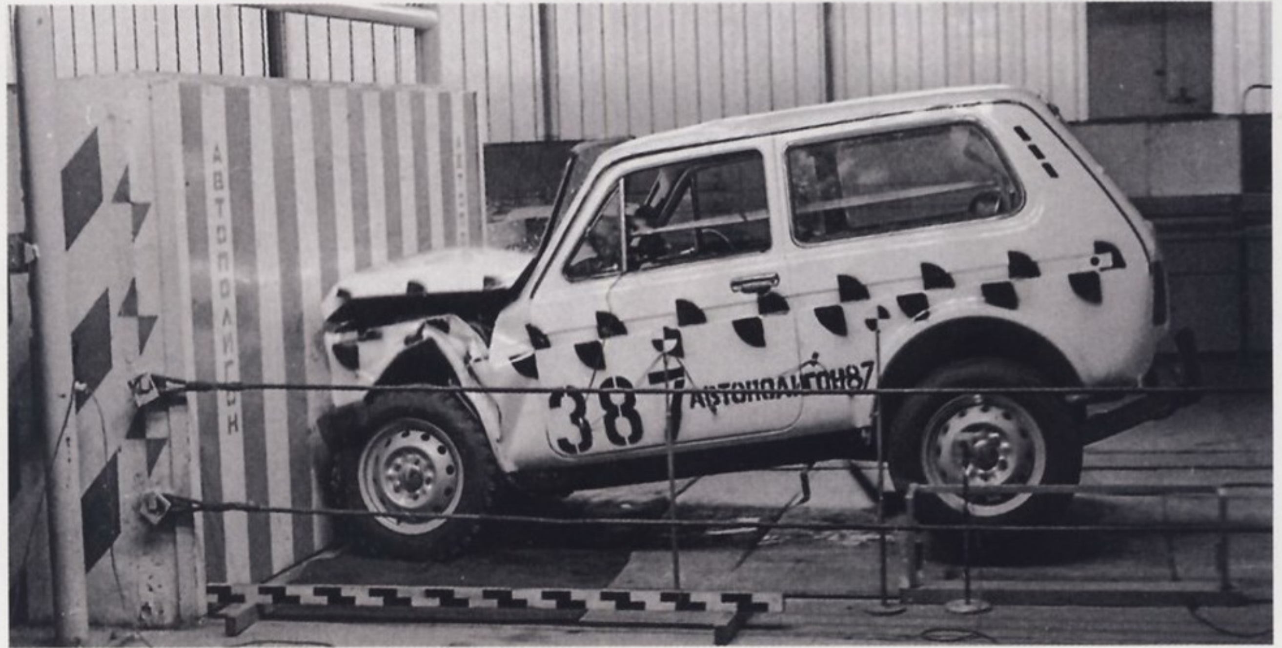
Фронтальный краш-тест ВАЗ-21213 «Нива» на автополигоне НАМИ в Дмитрове
