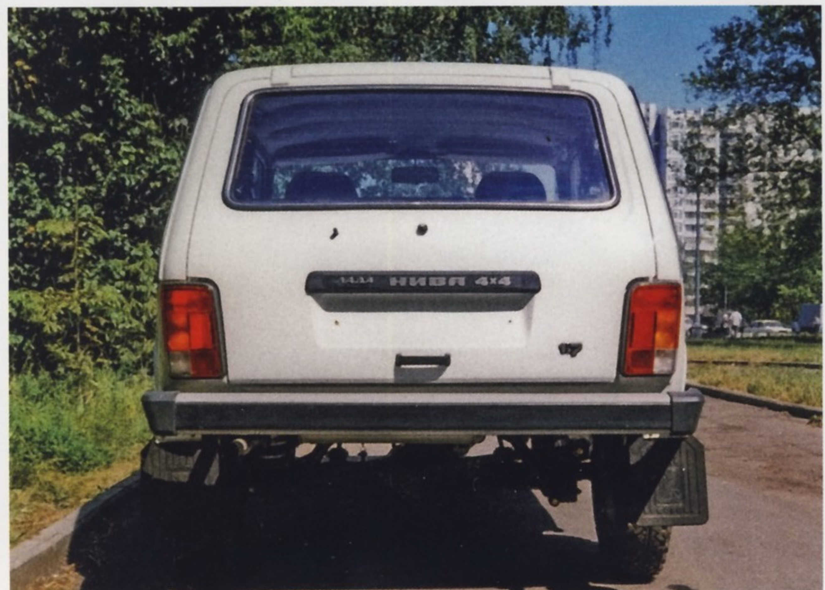
Проем задней двери ВАЗ-21213 был опущен до самого бампера для удобства погрузки вещей в багажник
