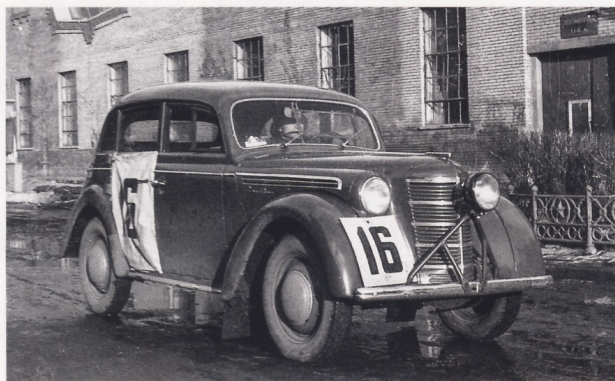
Автомобиль «Москвич-400-420», подготовленный к зимней ночной гонке от Москвы до Минска и обратно. Перед радиатором — третья фара, вместо заднего сиденья — бензобак от ЗИС-150
