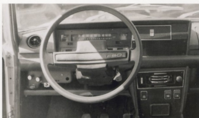
На приборном щитке в «кризисной» версии отсутствовал тахометр, обязательный для других комплектаций
