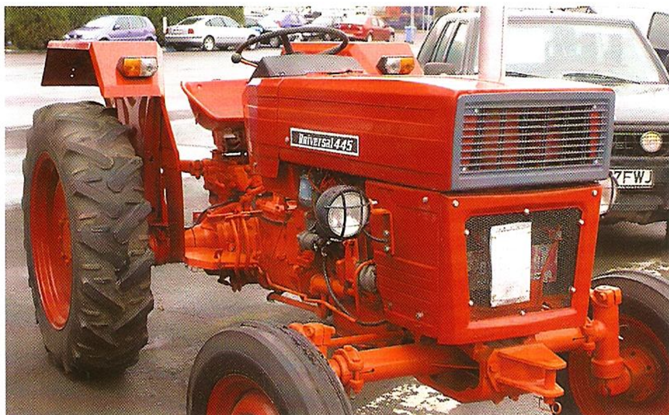
Трактор Universal 445 , у которого заимствовали дизельный двигатель для автомобилей ARO 24
