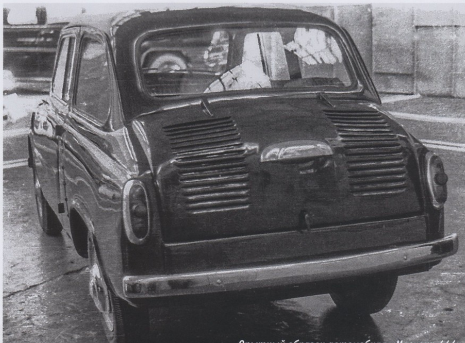
Опытный образец автомобиля «Москвич-444». Многочисленные прорезы на капоте свидетельствуют о проблемах с охлаждением двигателя
