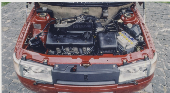
Моторный отсек прототипа ВАЗ-2111 с 16-клапанным двигателем
