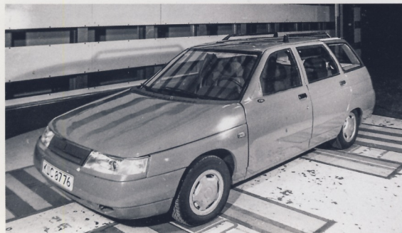
Продукта в аэродинамической трубе ВАЗ-2111 из предсерийной партии (1994 год)
