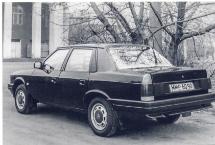
Образец АЗЛК-2142 четвертой серии черного цвета с двигателем АЗЛК-21414
