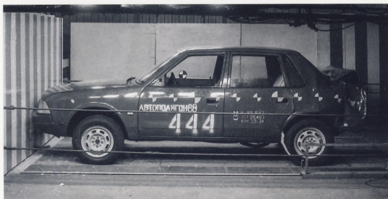
Испытания на наезд сзади седана АЗЛК-2112 (Дмитровский автополигон)
