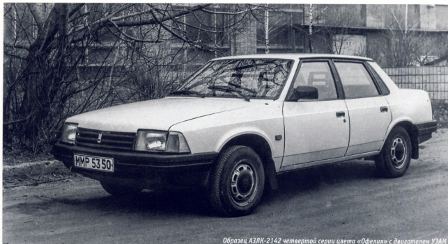
Образец АЗЛК-2142 четвертой серии цвета «Офелия» с двигателем УЗАМ
