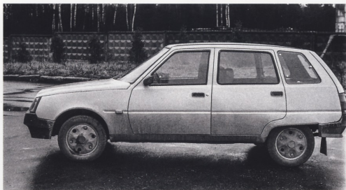
Опытный образец ЗАЗ-1105 на испытаниях. Обратите внимание на открывающиеся створки задних окон
