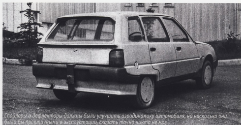
«Пластилиновым» изменениям для поиска лучшей аэродинамики подверглась не только передняя часть автомобиля, но и задняя
