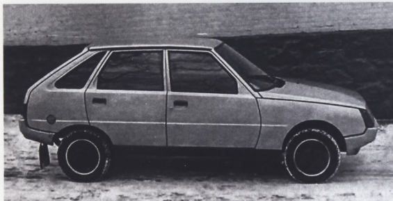
Опытный образец ЗАЗ-1102 с разным количеством дверей в боковинах: справа две, слева одна
