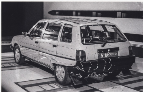
Опытный образец ЗАЗ-1105 на испытаниях в аэродинамической трубе на автополигоне НАМИ в Дмитрове
