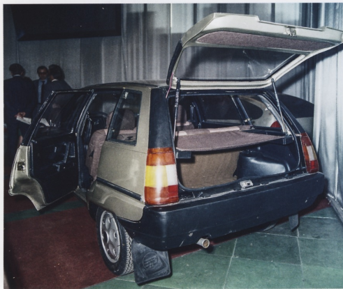
3A3-1105 имел кузов типа универсал с пятой подъемной дверью
