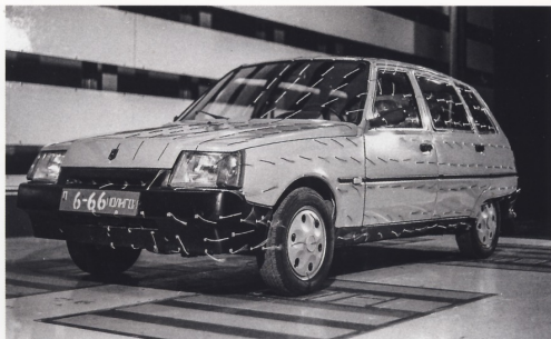
Опытный образец ЗАЗ-1105 на испытаниях в аэродинамической трубе на автополигоне НАМИ в Дмитрове
