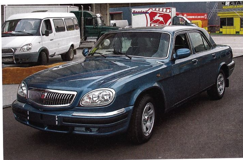
Опытный образец модификации автомобиля ГАЗ-31105, предназначенной для водителей-инвалидов
