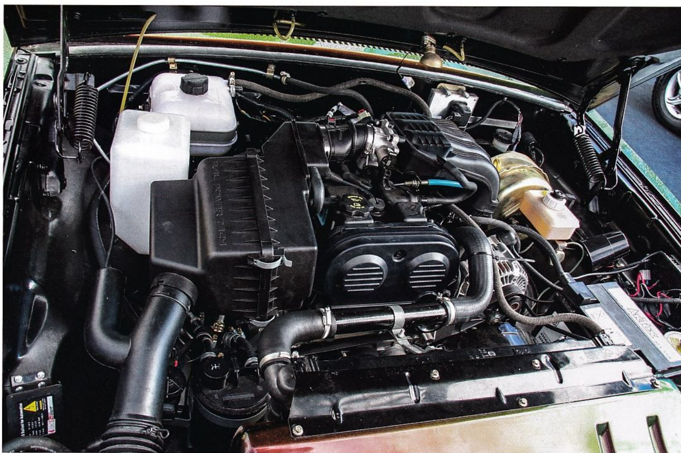
Двигатель Chrysler 2,4L DOHC, серийно устанавливавшийся на «Волгу»
