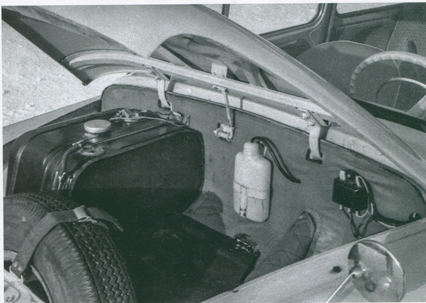
Расположение топливного бака и блока предохранителей в багажнике ЗАЗ-965 осложняло перемещение рулевого редуктора на правую сторону
