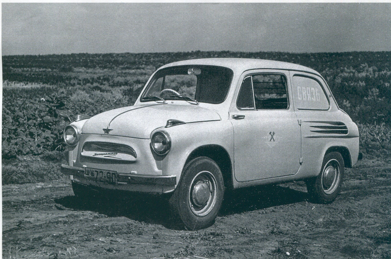
Опытный образец почтового автомобиля ЗАЗ-965С «Запорожец» с воздухозаборниками, не применявшимися на серийной модели
