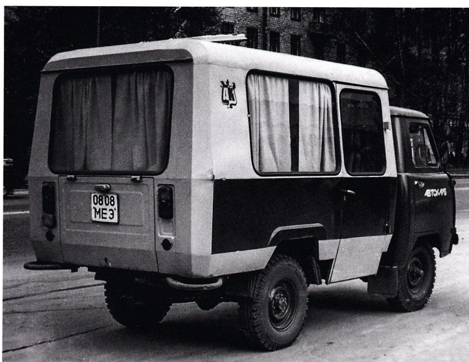
В стандартном исполнении сзади у Т-12.02 имелся люк для погрузки багажа
