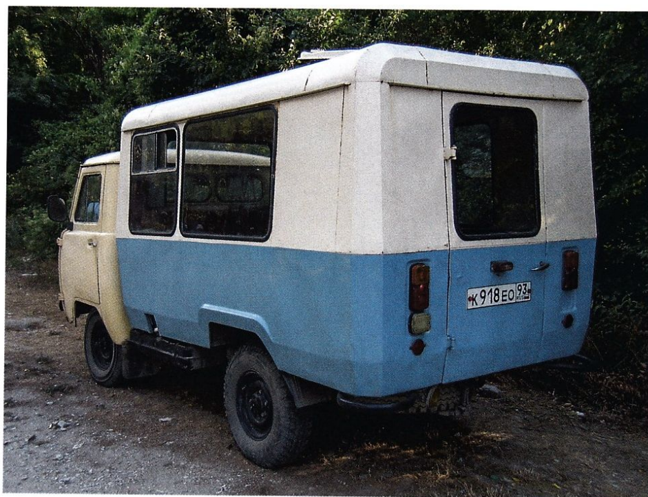
Исполнение Т-12.02 с дверью сзади вместо багажного люка
