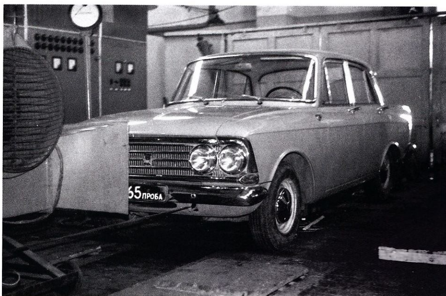
Испытания автомобиля «Москвич-408» в НАМИ
