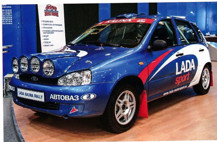
Модификация автомобиля Lada Kalina Sport для ралли с дополнительными фарами на капоте
