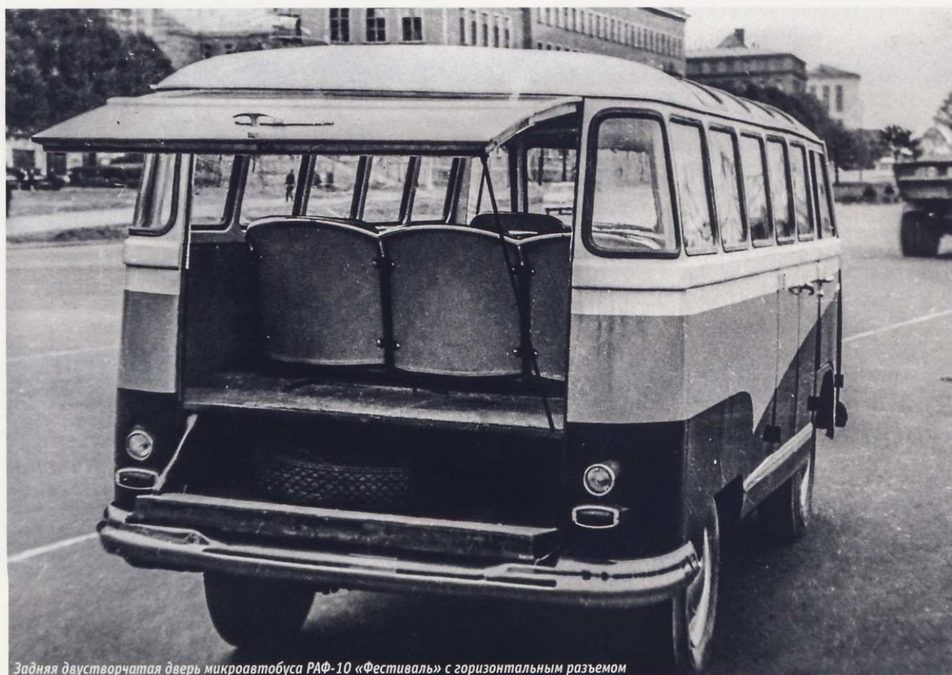
Задняя двустворчатая дверь микроавтобуса РАФ-10 «Фестиваль» с горизонтальным разъемом
