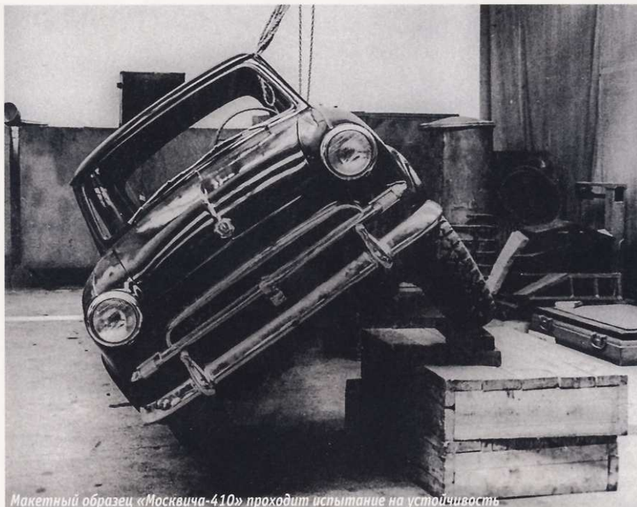
Макетный образец «Москвича-410» проходит испытание на устойчивость
