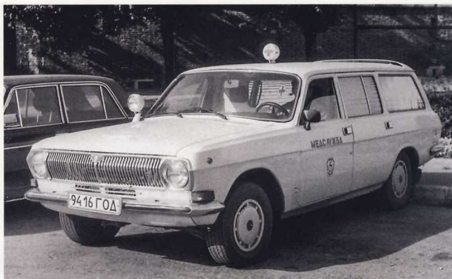
Переходный вариант ГАЗ-24-03 «Волга» с дверными ручками от модернизированного ГАЗ-24-10
