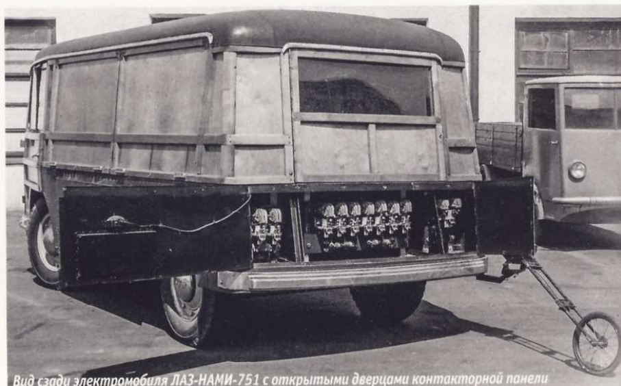
Вид сзади электромотоцикла ЛАЗ-НАМИ-751 с открытыми дверцами контакторной панели
