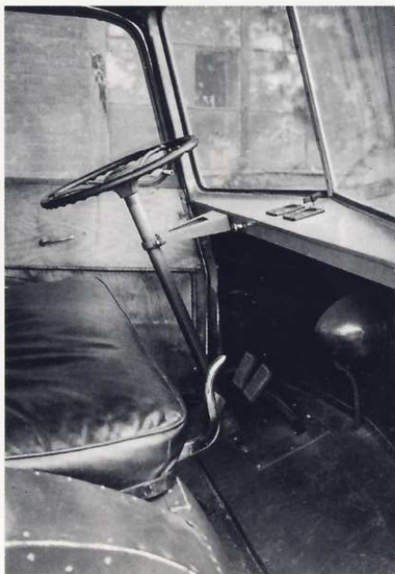
Вид на приборную панель и органы управления электромотовоза ЛАЗ-НАМИ-751
