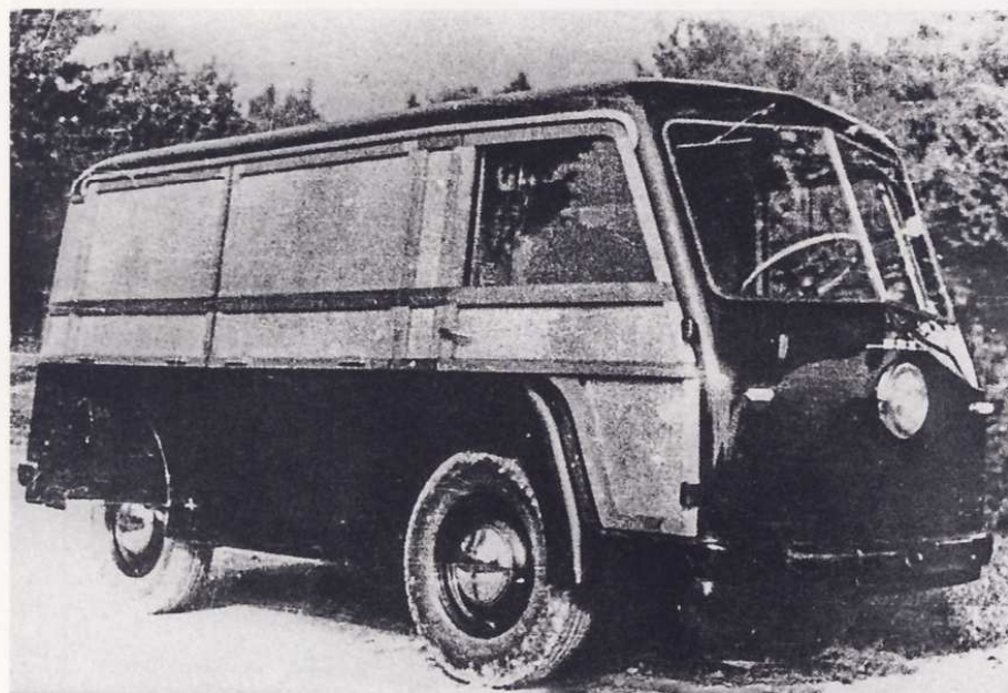
Электромобель ЛАЗ-НАМИ-750 грузоподъемностью 500 кг
