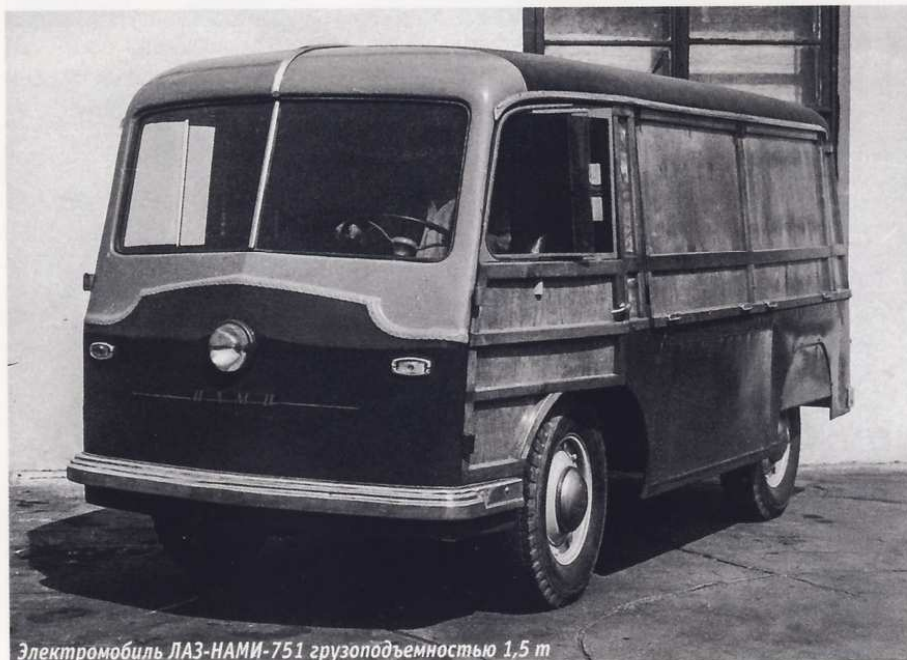
Электромобиль ЛАЗ-НАМИ-751 грузоподъемностью 1,5 т
