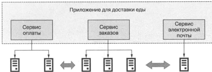
Рис. 1.1. В микросервисной архитектуре каждый сервис выполняет определенную бизнес-функцию и разворачивается как независимый компонент, который выполняется в собственном процессе
