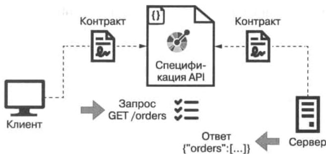
Рис. 1.4. Спецификация API представляет собой контракт между сервером и клиентом. Пока клиент и сервер следуют спецификации API, коммуникация будет происходить так, как ожидается
