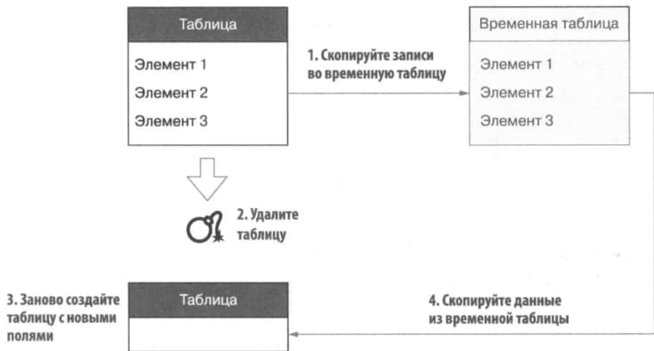
Рис. 11.11. При работе с SQLite для внесения изменений в таблицы мы используем пакетную обработку. Она позволяет нам копировать данные из исходной таблицы во временную; затем мы удаляем исходную таблицу и создаем ее заново с новыми полями; и, наконец, копируем обратно данные из временной таблицы
