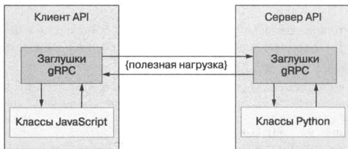
Рис. А.5. Заглушки, сгенерированные с помощью Protobuf, выполняют парсинг полезных данных, которыми обмениваются клиент и сервер API, и переводят их в нативный код
