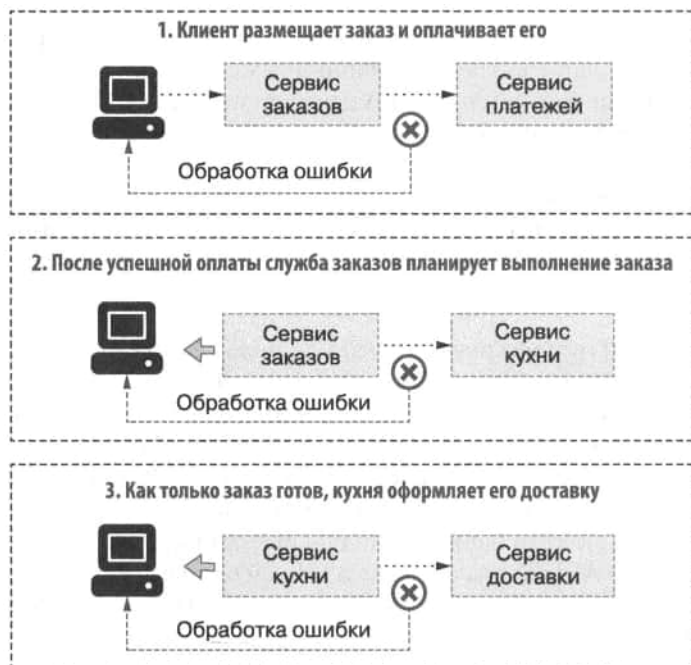
Рис. 1.6. Микросервисы должны быть устойчивы к таким событиям, как недоступность сервиса, тайм-аут запроса и ошибки обработки, полученные от других сервисов, и либо повторно выполнять запросы, либо выдавать пользователю понятный ответ
