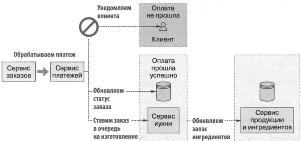
Рис. 1.7. Распределенная транзакция подразумевает взаимодействие между несколькими сервисами. Если какой-либо из них отказывает, то эта ситуация должна быть обработана и пользователю должен быть предоставлен понятный ответ
