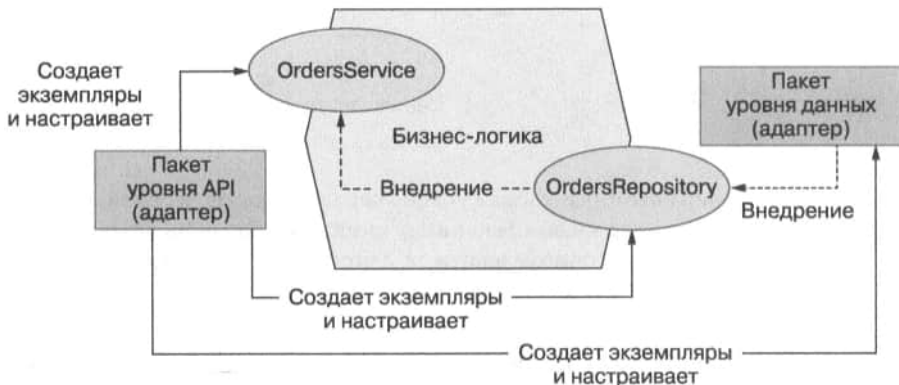
Рис. 7.13. С помощью инверсии управления мы отделяем компоненты от зависимостей, предоставляя их во время выполнения с помощью таких методов, как внедрение зависимостей. Сплошные линии показывают отношения зависимостей, в то время как пунктирные обозначают, как происходят внедрения зависимостей
