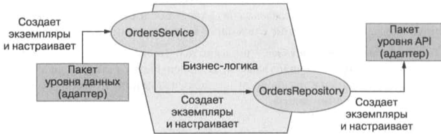
Рис. 7.12. При обычном проектировании программного обеспечения зависимости линейны и каждый компонент отвечает за создание экземпляров и настройку собственных зависимостей
