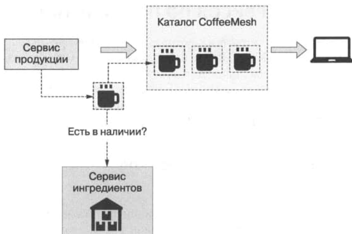
Рис. 3.4. Чтобы определить, доступен ли товар, сервис продукции проверяет запас ингредиентов в соответствующем сервисе
